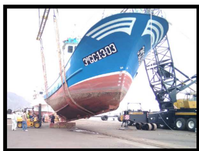
Ilustración nº 104. Colocando maderos de varada. Fuente: Trabajo de campo.
