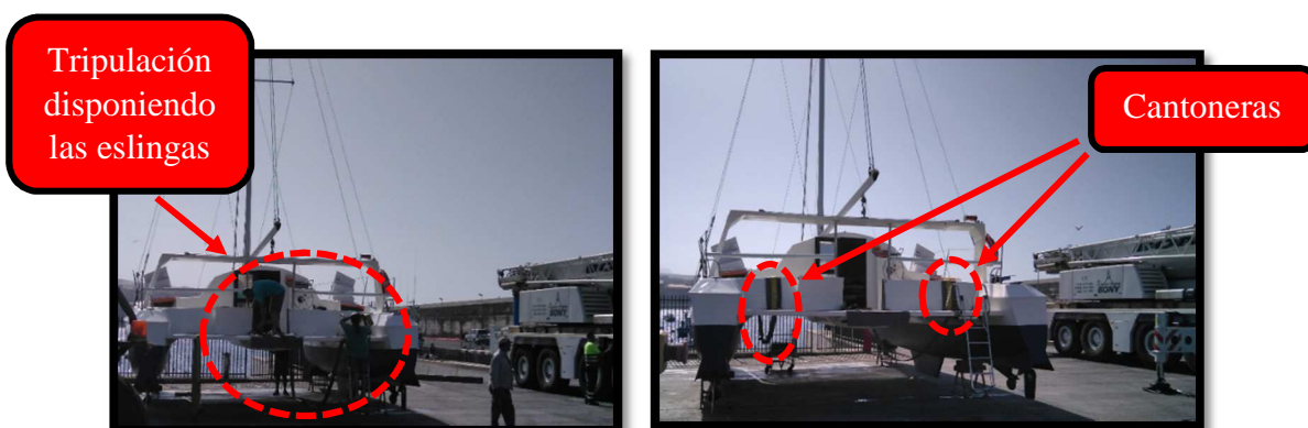
Ilustración nº 172. Preparando eslingas sobre la embarcación. Fuente: Trabajo de campo.
