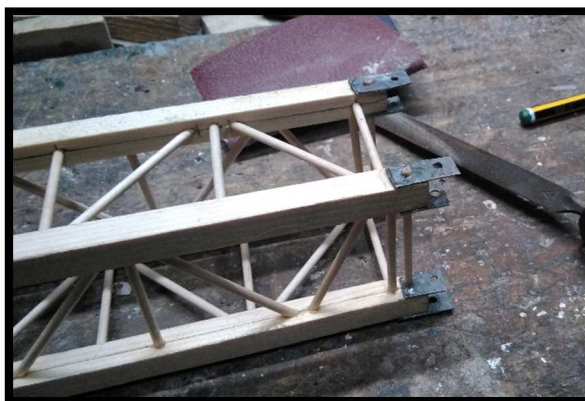
Ilustración nº 196. Sistema de unión desmontable de los tramos de pluma de celosía.
