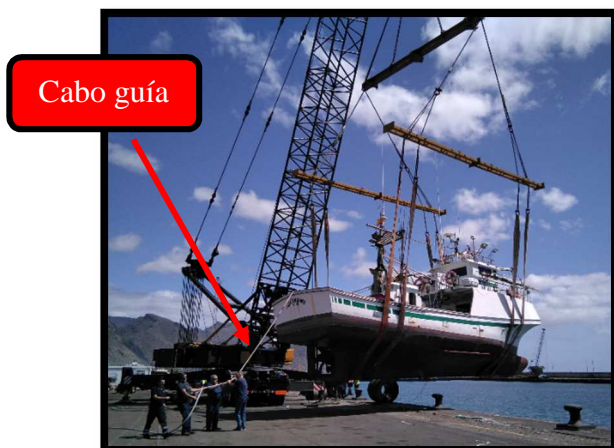
Ilustración n° 81. Traslado del buque.
