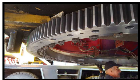
Ilustración n° 27. Detalle de una corona de orientación. Fuente: [31].
