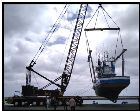
Ilustración nº 102. Girando el buque. Fuente: Trabajo de campo.
