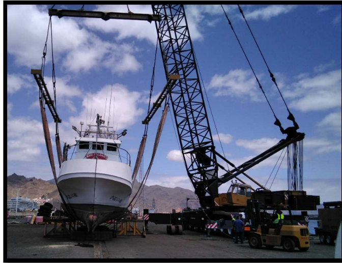
Ilustración nº 91. Buque “JOSE Y ALBANO” sobre su cama de varada. Fuente: Trabajo de campo.
