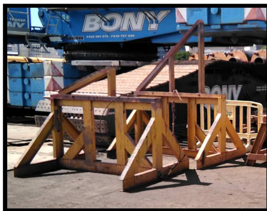
Ilustración nº 131. Burras de varada. Fuente: Trabajo de campo.
