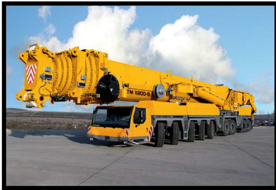
Ilustración nº 18. Grúa móvil autopropulsada con sistema de traslación sobre ruedas neumáticas. Fuente: [26].
