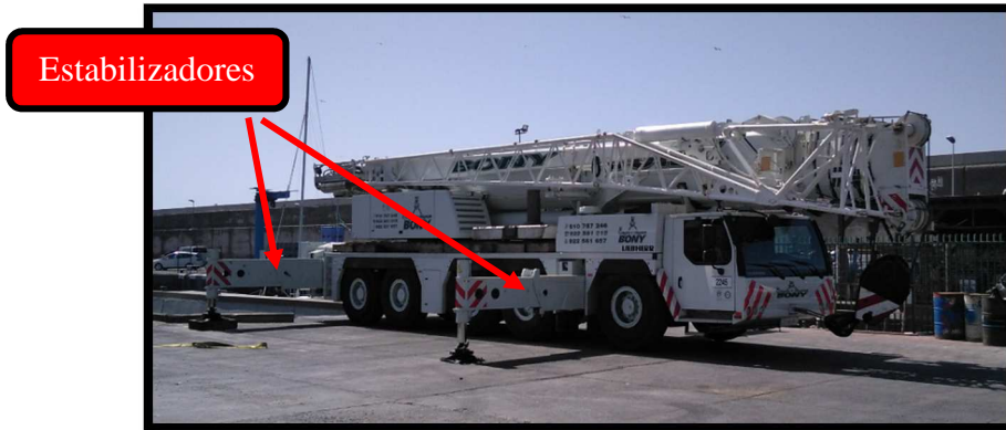
Ilustración nº 167. Grúa “Liebherr LTM 1220-5.1” en posición y con los estabilizadores desplegados. Fuente: Trabajo de campo.
