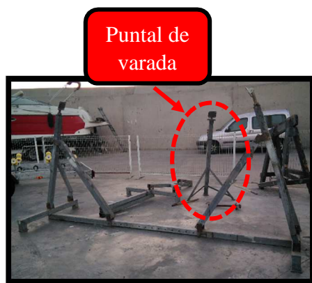
Ilustración n° 159. Burra y puntal de varada. Fuente: Trabajo de campo.
