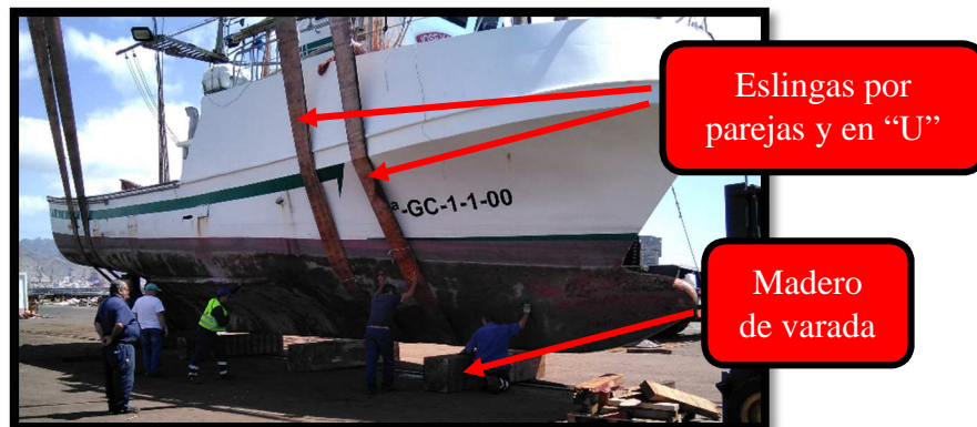
Ilustración n° 85. Aproximando el buque a los maderos de varada.
