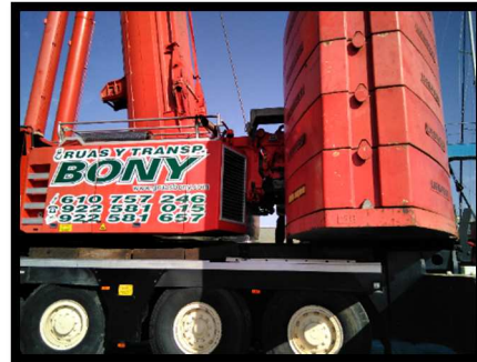
Ilustración n° 146. Cama de contrapesos acoplada. Fuente: Trabajo de campo.
