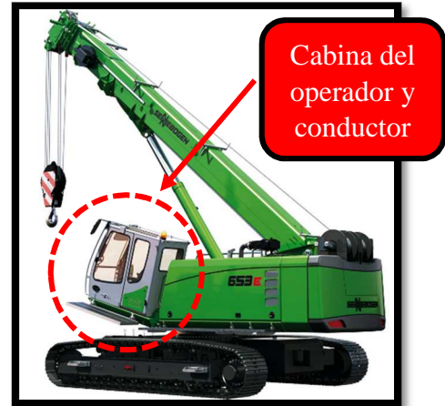
Ilustración nº 36. Cabina del operador y conductor de un modelo de grúa. Fuente: [40].
