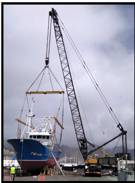
Ilustración nº 130. Tensando aparejos de izado. Fuente: Trabajo de campo.
