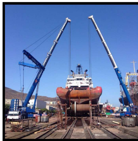
Ilustración n° 16. Grúas telescópicas realizando una maniobra de elevación en tándem en un puerto.
