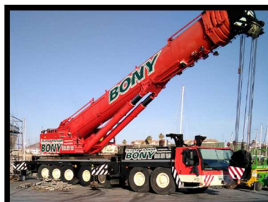
Ilustración nº 141. Grúa “Liebherr LTM 1400-7.1” situada a popa-estribor del buque. Fuente: Trabajo de campo.
