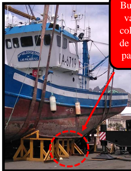
Ilustración n° 107. Burra de varada de asiento longitudinal en posición.
