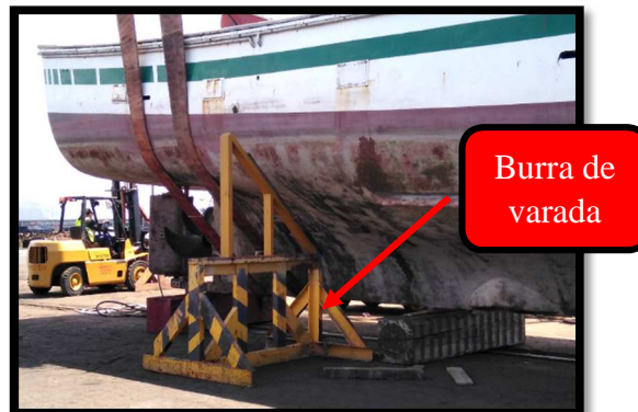
Ilustración n° 87. Burra de varada en posición.
