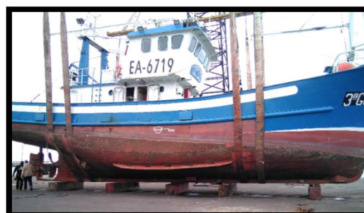
Ilustración nº 105. Quilla asentada sobre los maderos de varada. Fuente: Trabajo de campo.
