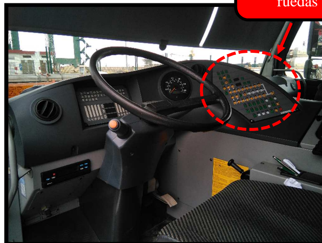
Ilustración nº 21. Cabina de conducción de una grúa móvil autopropulsada.
