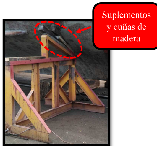
Ilustración n° 89. Burra de varada con suplementos y cuñas de madera. Fuente: Trabajo de campo.
