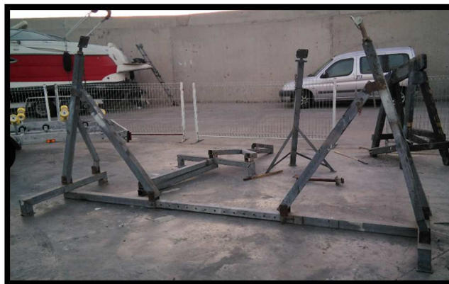
Ilustración n° 117. Burrá de varada. Fuente: Trabajo de campo.
