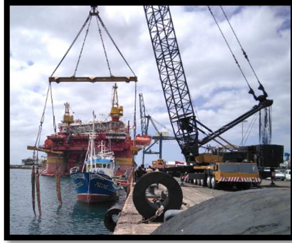
Ilustración n° 99. Buque aproximándose a los aparejos de izado. Fuente: Trabajo de campo.
