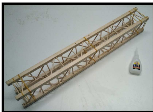
Ilustración n° 185. Primer tramo de pluma montado. Fuente: Elaboración propia.
