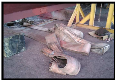
Ilustración n° 128. Eslingas dispuestas bajo la quilla. Fuente: Trabajo de campo.
