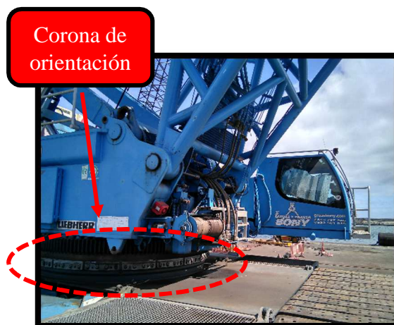
Ilustración n° 26. Corona de orientación de la grúa móvil autopropulsada “Liebherr LR 1600/2”. Fuente: Trabajo de campo.
