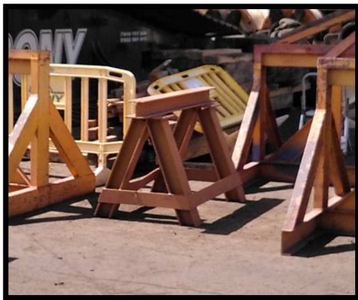
Ilustración n° 106. Burra de varada de asiento paralelo.
