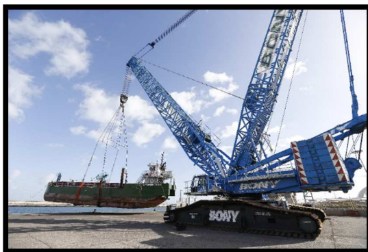
Ilustración n° 15. Maniobra de varada del buque “Atlantshipservice Dos” empleando la grúa “Liebherr LR 1600/2”.
