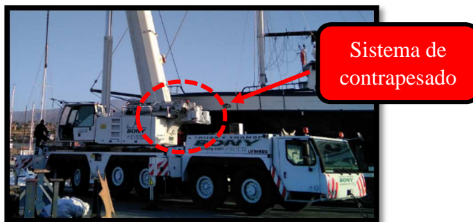
Ilustración n° 150. Sistema de lastre de la grúa LTM 1250. Fuente: Trabajo de campo.
