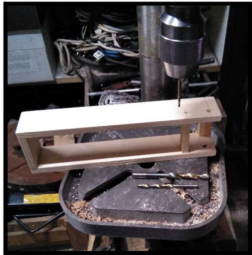
Ilustración nº 197. Practicando orificios en la superestructura. Fuente: Elaboración propia.
