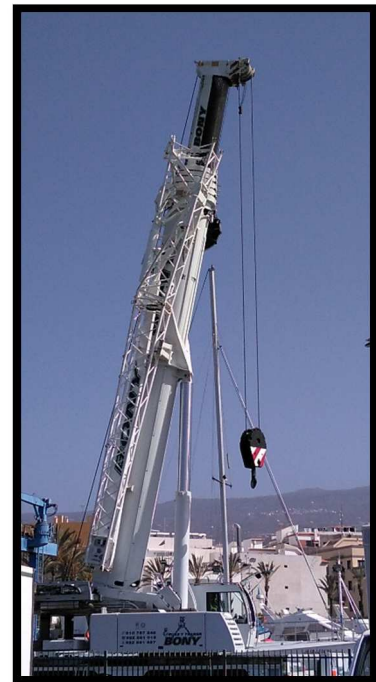
Ilustración n° 169. Desplegando tramos del brazo telescópico. Fuente: Trabajo de campo.
