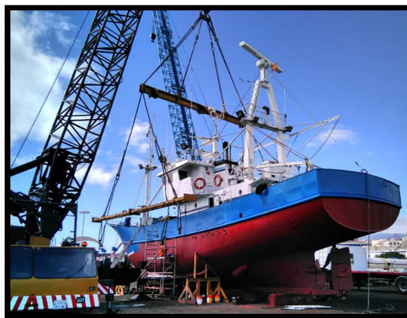
Ilustración n° 127. Separadores en posición. Fuente: Trabajo de campo.
