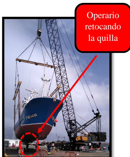
Ilustración n° 133. Retocando la quilla. Fuente: Trabajo de campo.
