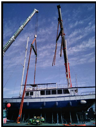
Ilustración n° 155. Disponiendo aparejos de izado de popa. Fuente: Trabajo de campo.
