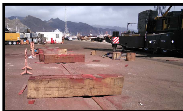
Ilustración n° 134. Maderos de varada donde asentó la quilla. Fuente: Trabajo de campo.
