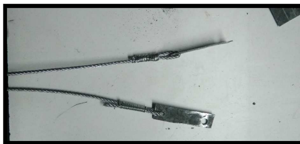
Ilustración nº 203. Resultado final en los extremos del mismo cable fijador. Fuente: Elaboración propia.
