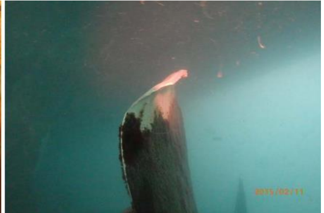
Ilustración 23: Deformación en la pala de la hélice - Fuente: https://www.fomento.gob.es/organos-colegiados/ciaim
