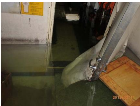
Ilustración 22: Inundación sala maquinas 2 - Fuente: https://www.fomento.gob.es/organos-colegiados/ciaim
