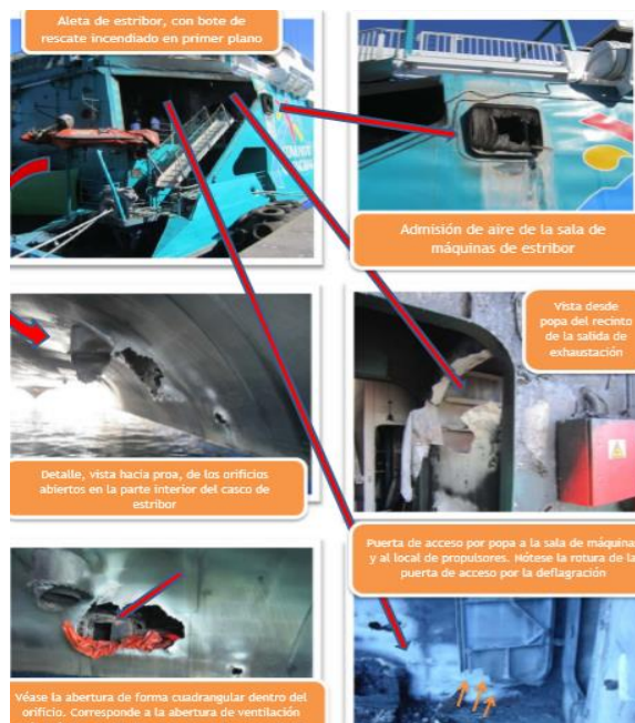
Ilustración 16: Estado del Jaume I después del incendio - Fuente: https://www.fomento.gob.es/organos-colegiados/ciaim
