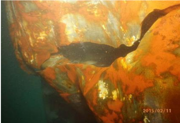
Ilustración 24: Grieta en la zona de pantoque - Fuente: https://www.fomento.gob.es/organos-colegiados/ciaim
