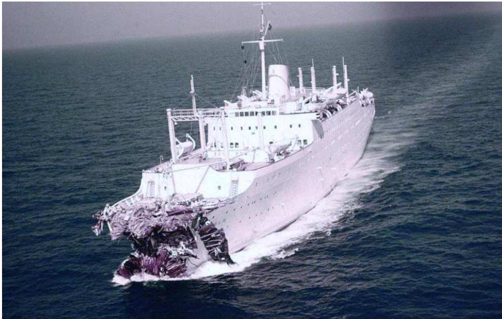
Ilustración 33. Stockholm bow damages. Fuente [22]
