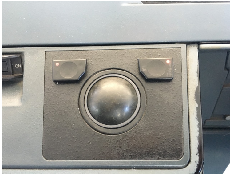
Ilustración 18. Ratón radar buque Al Andalus Express. Fuente (Trabajo de campo)
