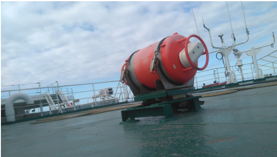
Ilustración 15. Recipiente VDR buque Volcan de Tijarafe. Fuente (Trabajo de campo)
