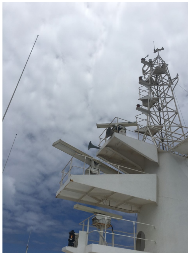
Ilustración 10. Antenas radar buque Al Andalus Express. Fuente (Trabajo de campo)
