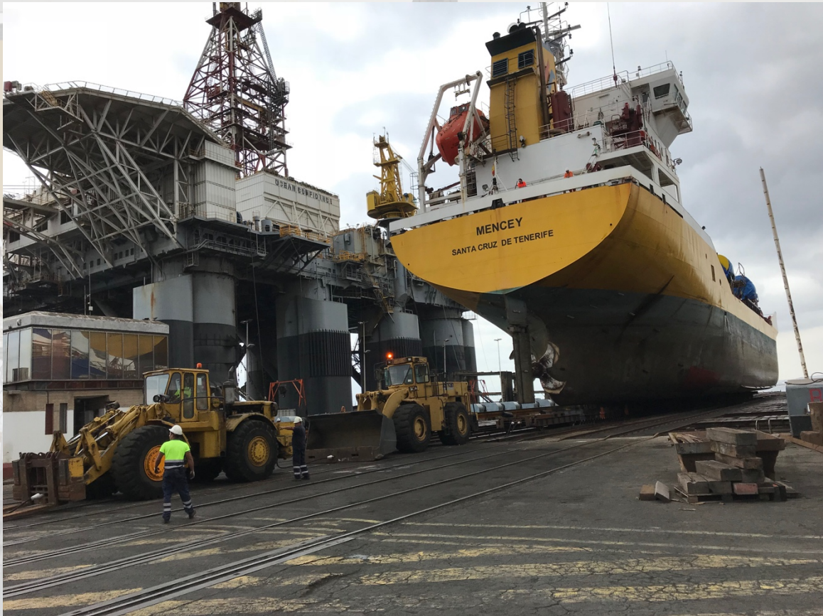
Ilustración 24. Proceso de tracción del buque hasta su posición asignada en el astillero
