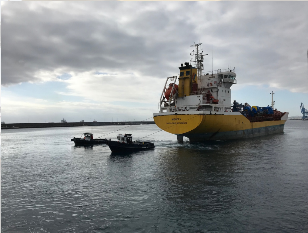
Ilustración 23. Falúas de puerto aproximando al B/T Mencey a la cuna del dique flotante.
