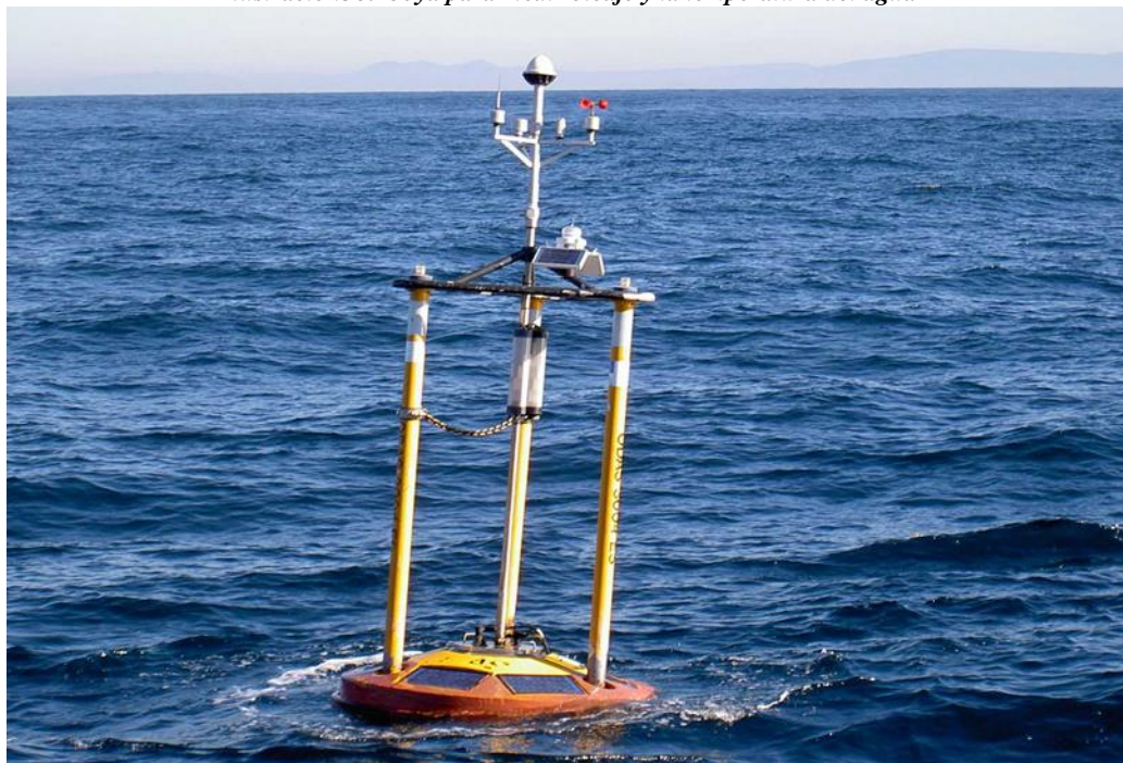
Ilustración38: boya para medir oleaje y la temperatura del agua
