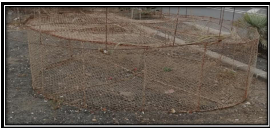
Ilustración n°40. Nasa en deteriorada por corrosión.
