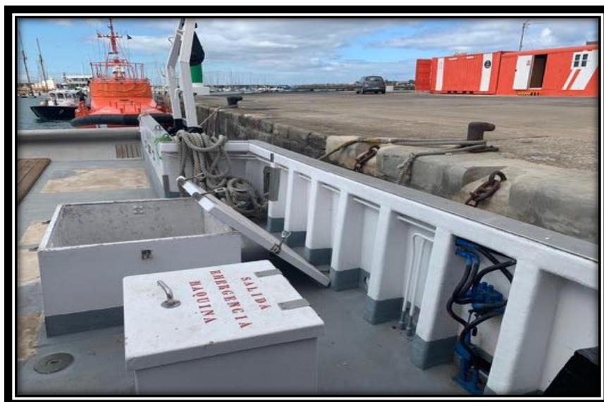
Ilustración nº70, Maquinilla hidráulica y mandos de la misma.
