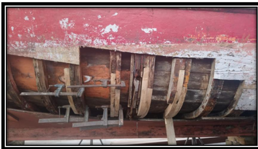
Ilustración nº 74. Refuerzo y reparación de las Cuadernas y pantoque.
