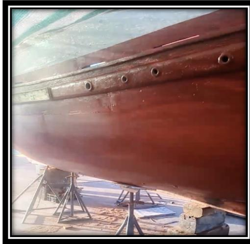
Ilustración nº 75, Acabado superficial del forro tras la reparación.
