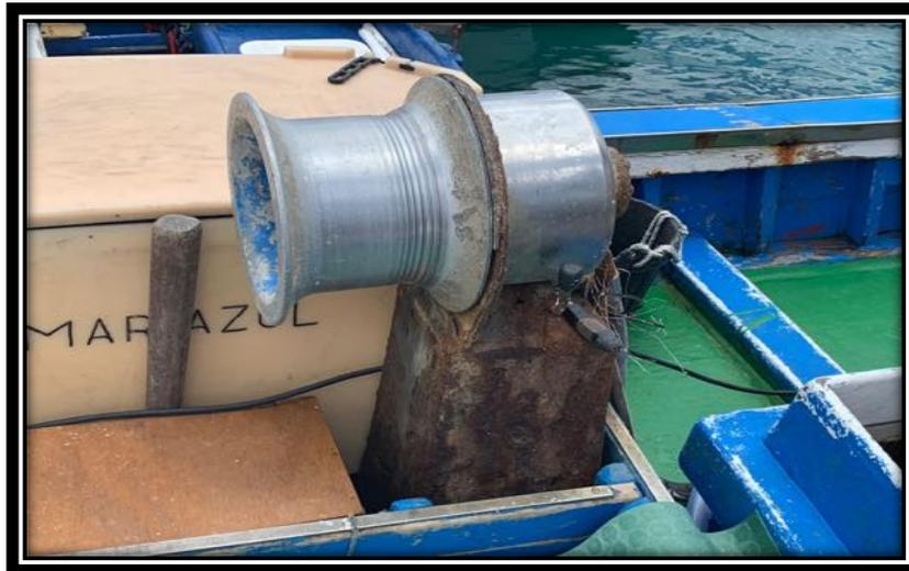
Ilustración nº 65, Maquinilla hidráulica.
