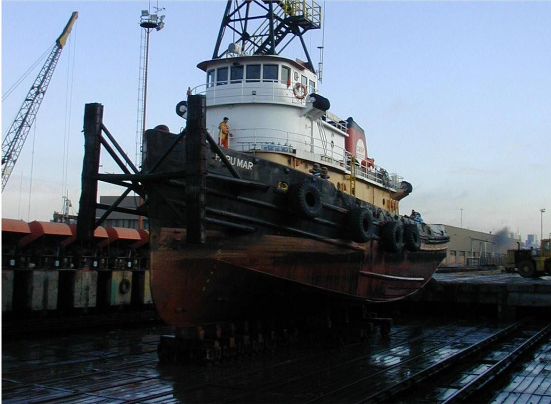
**Ilustración 23: Remolcador en un syncrolift. Fuente: Wikipedia**
