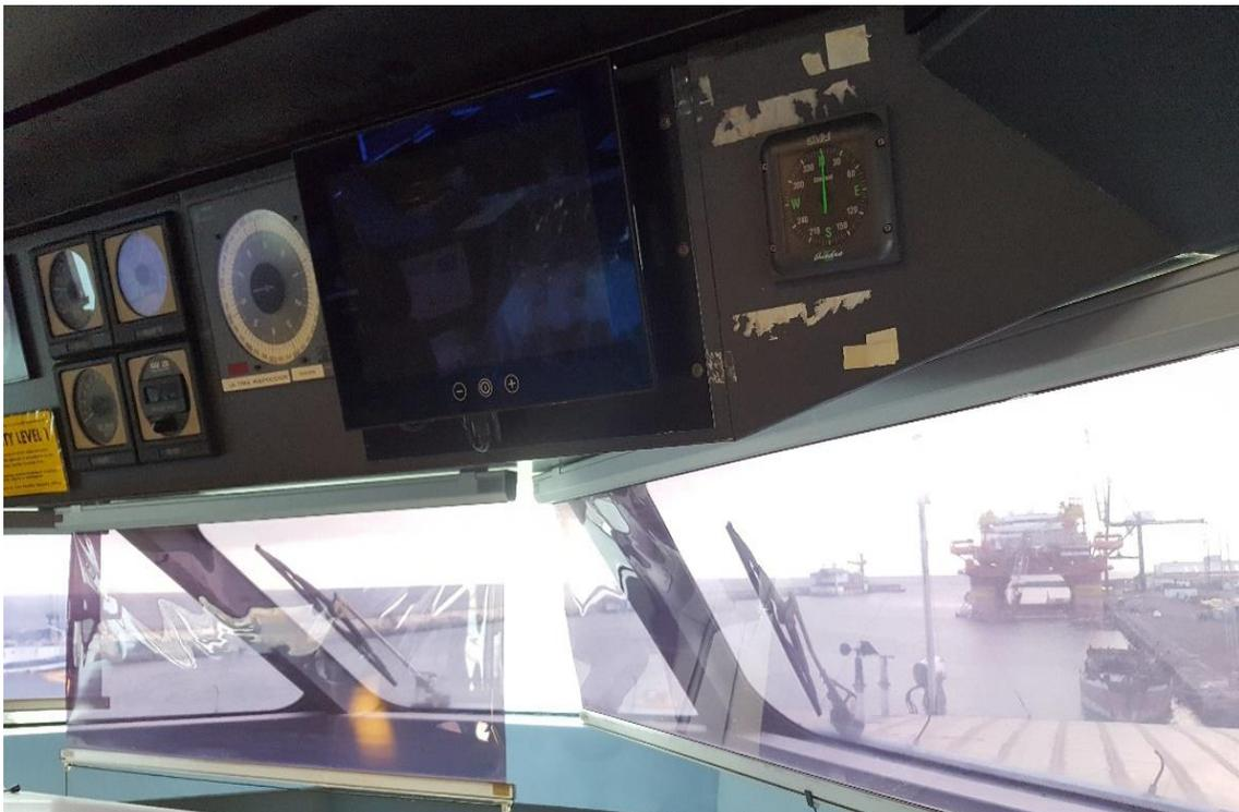
**Ilustración 53: Night vision instalado. Fuente: Elaboración propia.**
