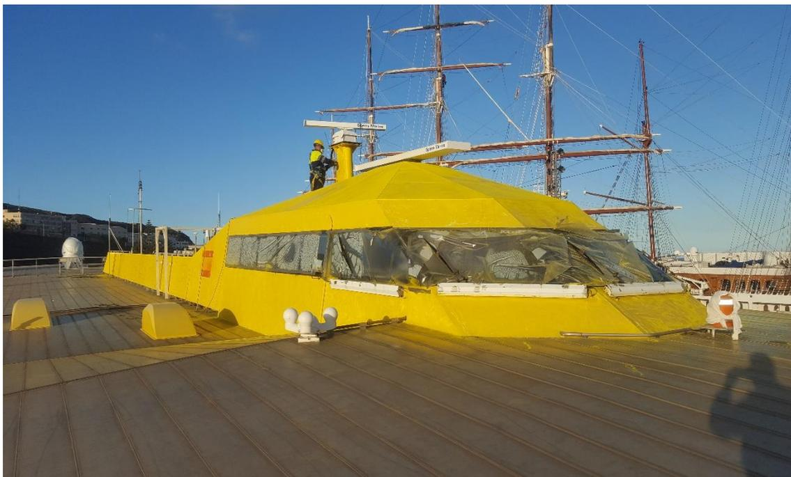
**Ilustración 39: Lijado puente del buque. Fuente: Elaboración propia.**
