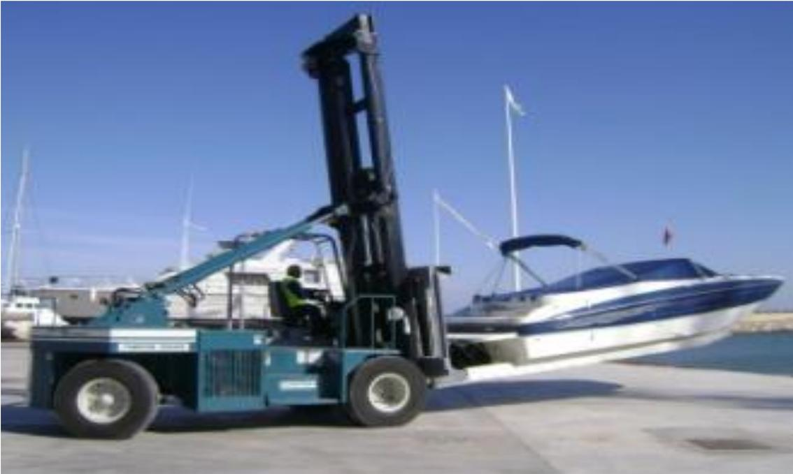
**Ilustración 18: Forklift. Fuente: Web Prezi, Sistemas de varada y puesta a flote.**
