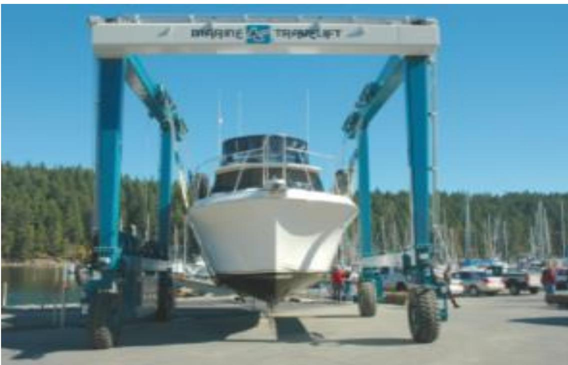
**Ilustración 16: Travelift. Fuente: Web Prezi, Sistemas de varada y puesta a flote.**
