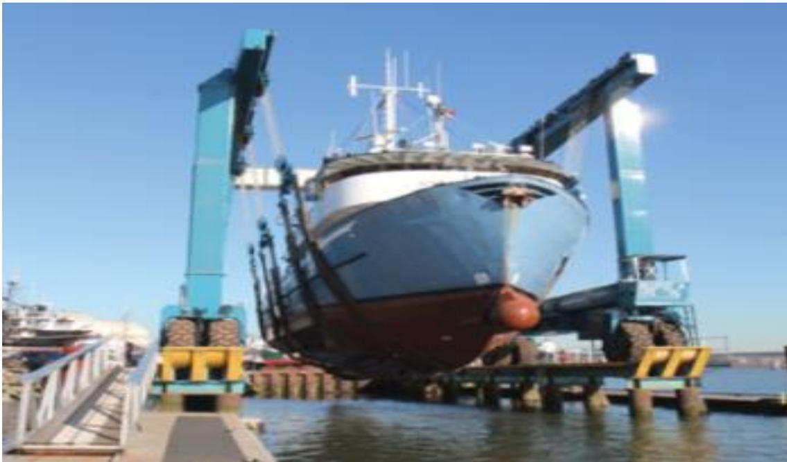
**Ilustración 17: Otro ejemplo de travelift. Fuente: Web Prezi, Sistemas de varada y puesta a flote.**
