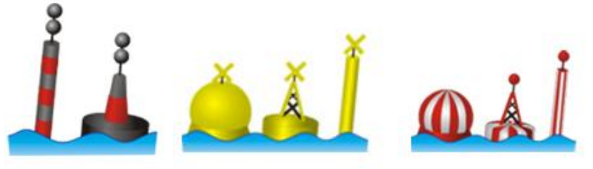
Figura 13: Cilíndrica, Castillete y Espeque de Peligro Aislado, Señales Especiales y Aguas Navegables Seguras.
