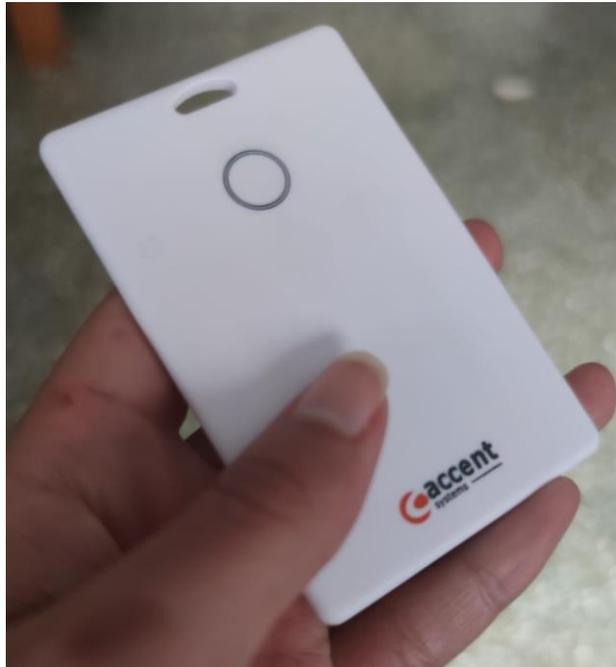
Figura 14 : Dispositivo bluetooth beacon
