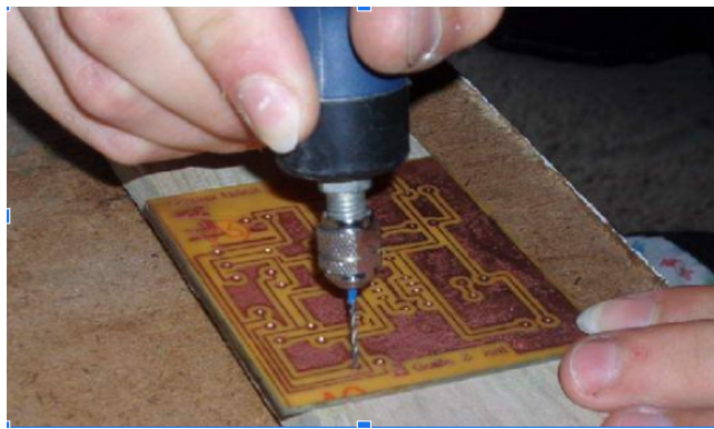
Figura 17: Taladrado de la PCB
