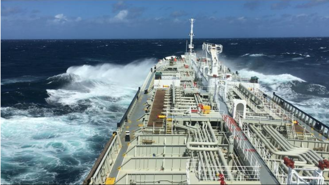
15 Vista desde el puente de Líneas, colectores y manifolds. Archivo: Pablo Fortuny
