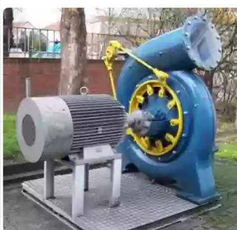
Figuras 5.2 y 5.3: Fotografía de una turbina Francis (izq) y Pelton (dcha). Fuente: solar-energia.net
