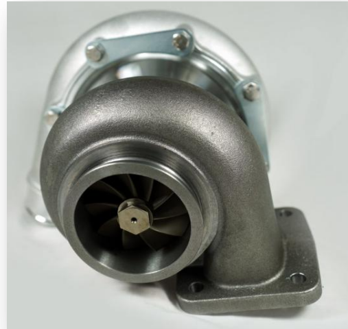
Figuras 5.4 y 5.5: Fotografía anterior (izq) y posterior (dcha) de un turbocharger. Fuente: theboostlab.com
