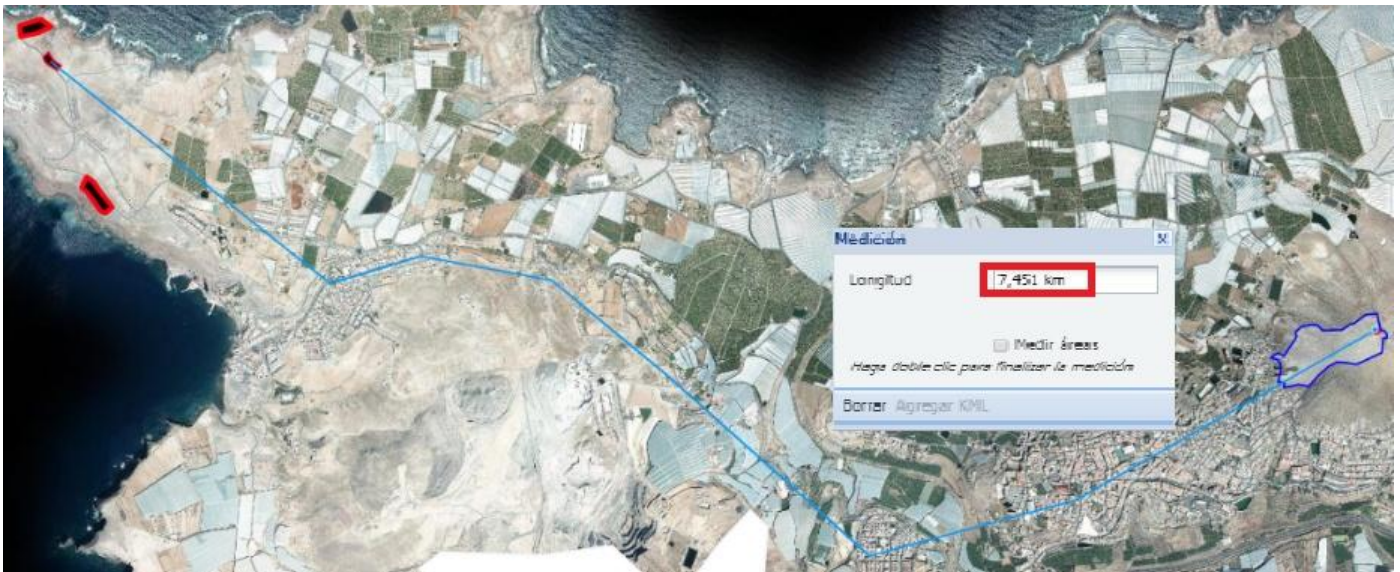
Figura 3.9: Distancia aproximada entre el depósito de regulación y la EDAM. Fuente: Grafcan
