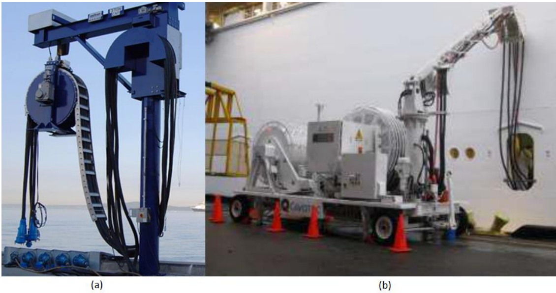
Ilustración 12. Grúas de elevación (a) Base fija (b) Base móvil. Fuente: poweratberth.eu (16)
