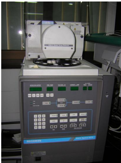
Figura III.2.3 Imagen del equipo CE utilizado en esta Tesis Doctoral.
