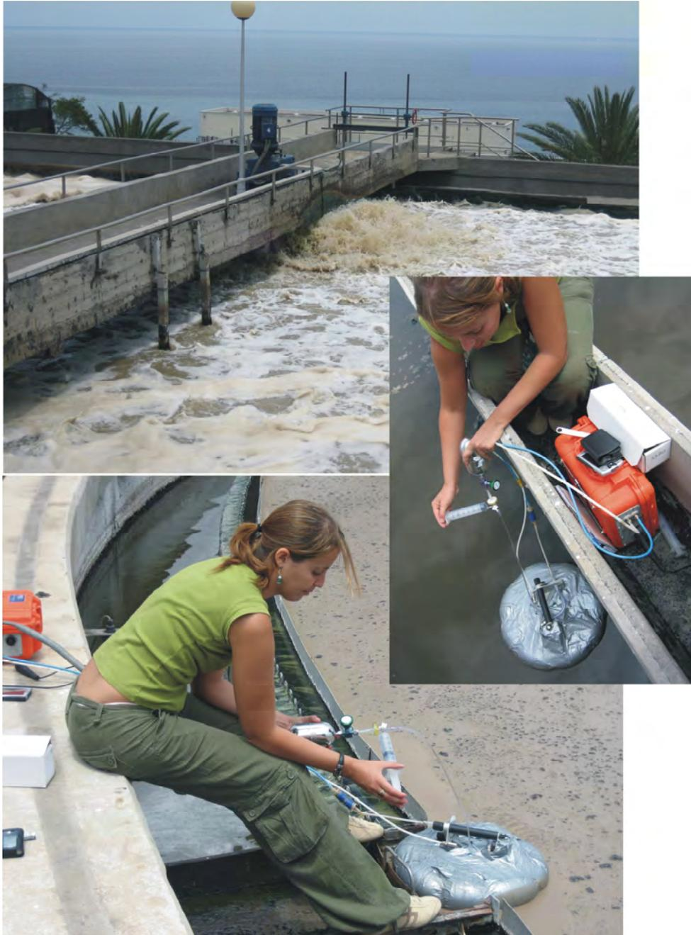
**Figura 4.3.-** Toma de una muestra del aire ambiente en la interfase aire-agua residual del interior de la cámara de acumulación en la planta de agua residual (EDAR) de Santa Cruz de Tenerife.
