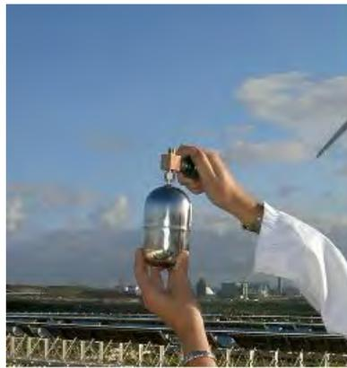
**Figura 2.3-** Fotografía en detalle de un canisters, botellas de acero inoxidable, cuyo interior está electropulido y en el cual la muestra del aire ambiente se introduce mediante vacío.
