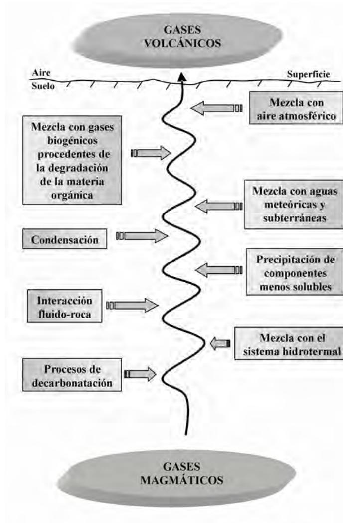
**Figura 7.4.** Procesos secundarios que pueden modificar la composición química de los gases magmáticos durante su ascenso hacia la superficie. Los gases magmáticos modificados que alcanzan la superficie se denominan gases volcánicos.
