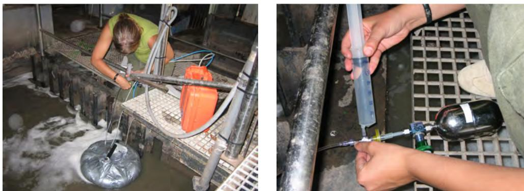
**Figura 4.4** Toma de muestra de gas en el aire ambiente superficial de la Planta Depuradora de Agua Residual (EDAR) mediante el uso canisters de acero inoxidable previamente evacuados al vacío
