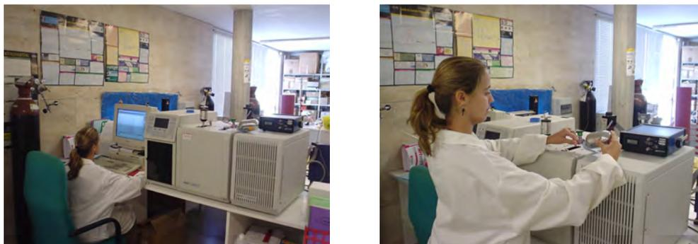
**Figura 2.4** Foto panorámica del cromatógrafo de gases GC/MS/MS modelo VARIAN Saturn 2000.
