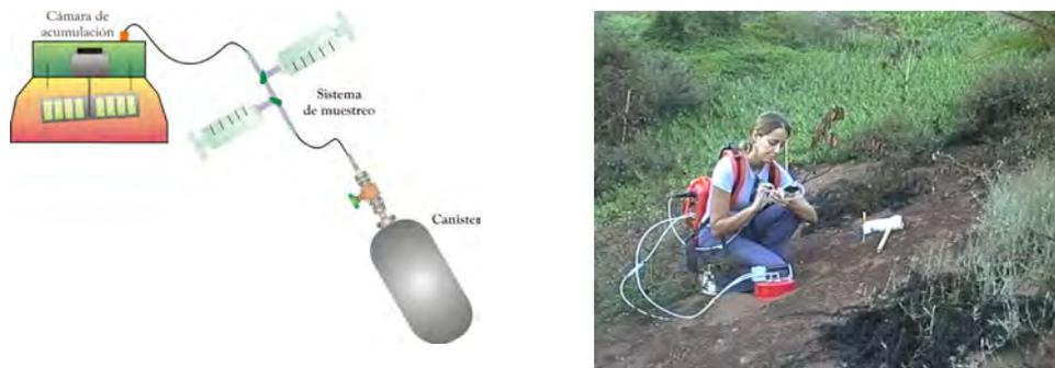
**Figura 3.8.-** Esquema del sistema de toma de muestra desde el interior de la cámara de acumulación y fotografía de una medida de flujo en la cobertera superficial del vertedero de Lazareto mediante el uso de NDIR (sensor de infrarrojo no dispersivo).
