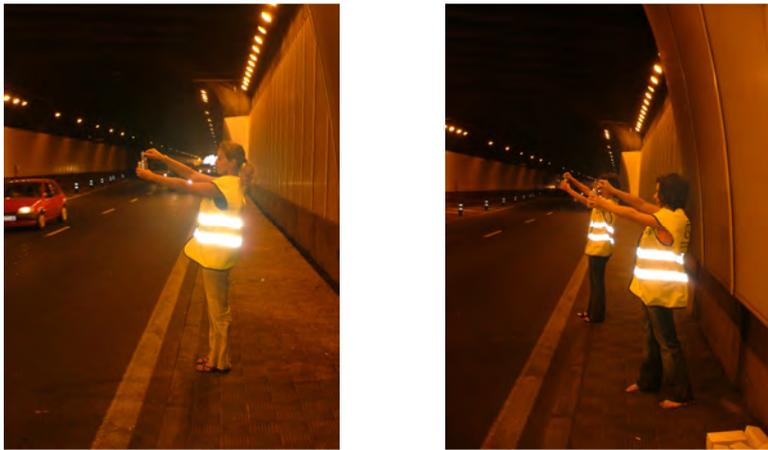
**Figura 2.2.-** Toma de muestras del aire ambiente en el interior del Túnel de la Avenida Tres de Mayo.
