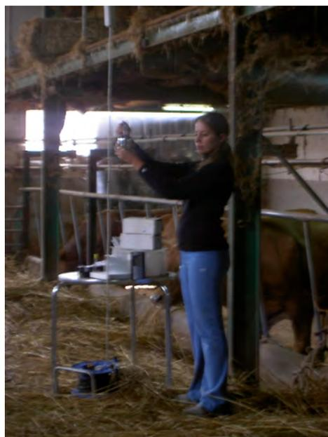
**Figura 6.2.-** Toma de muestras de COVs no metanizados en el interior de la vaquería durante el periodo de estudio.
