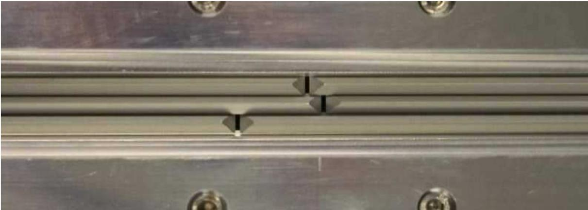
Figura 1.6: Detalle del prototipo de 6 barras de la CSU en el que se puede apreciar cómo se configuran las rendijas.
