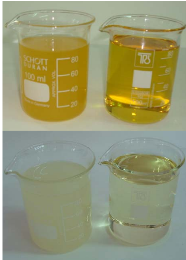
Figura V.15.- Biodiesel obtenido a partir de aceite de fritura (arriba) y sin usar (abajo), antes (izquierda) y después (derecha) de las etapas de lavado y secado.
