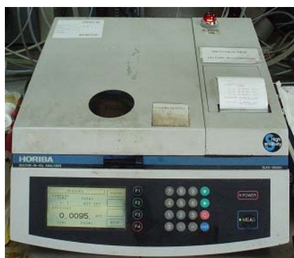
Figura III.11.- Espectrómetro de fluorescencia de rayos X, empleado para la determinación del contenido en azufre.
