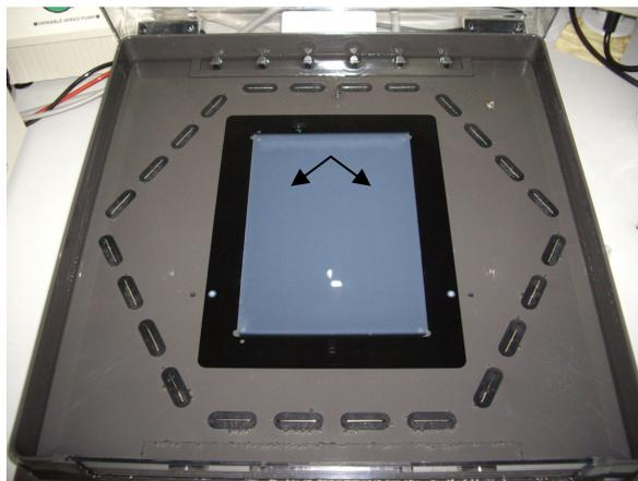
**Figura 2. 22.** Gel en el interior de la cubeta del sistema CHEF de electroforesis de campo pulsado. El ángulo de  $120^\circ$  indicado, es el ángulo de reorientación del campo eléctrico entre los diferentes lados del hexágono en el que están distribuidos los electrodos.
