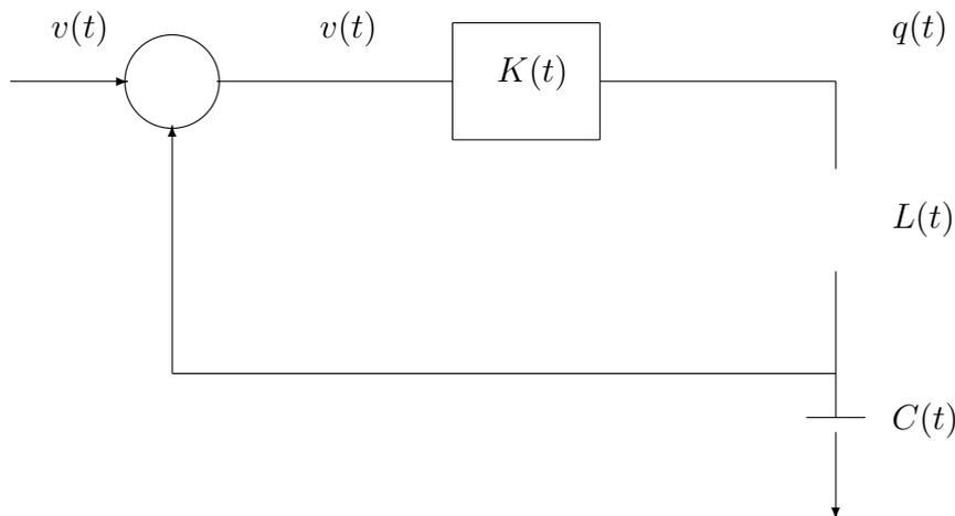
compuesto de una fuente de voltaje  $v(t)$ , un amplificador  $K(t)$ , un condensador  $C(t)$  y un inductor  $L(t)$ , todos ellos dependientes del tiempo. Si se tienen, además las relaciones:
