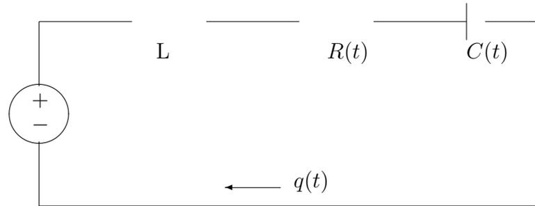
El circuito lo forman una fuente de voltaje  $v(t)$ , una inductancia constante  $L$ , una resistencia  $R$  que depende del tiempo por medio de la relación ( $\alpha$  y  $\mu$  representan parámetros reales)
