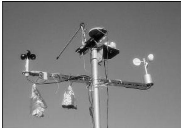
Fotografía. 1 Estación meteorológica, con varios sensores de radiación, temperatura del aire y velocidad del viento.
