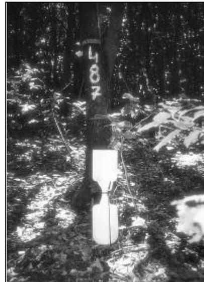
Foto. 5 Colector de la precipitación penetrante (Pp) mediante embudos de 170 mm.
