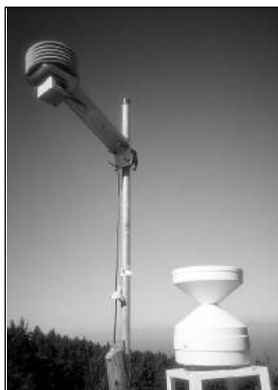
Fotografía. 2 De izquierda a derecha sensores de temperatura y humedad y pluviómetro
