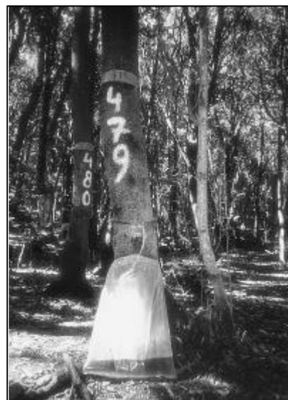
Fotografía 4. Medida del escurrido cortical mediante un collar de caucho.
