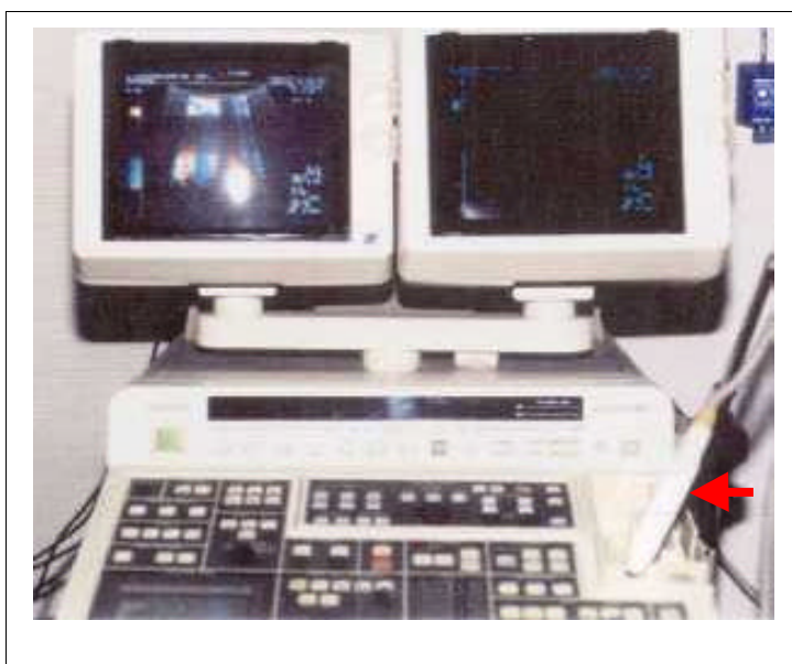
FIGURA 4.1: ECOGRAFO DOPPLER COLOR TOSHIBA 370 SSA HR. DOBLE MONITOR (Blanco/Negro y Color). *Flecha: Transductor Lineal Electrónico de 7.5 MHz.
