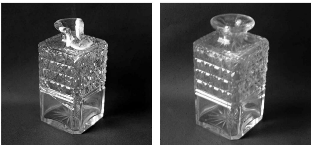
Ilustración 16 y 16.1. Reintegración realizada en resina epoxi a partir de la reproducción de un molde. (Fotografías extraídas de la fuente Davinson, 2008:293)
