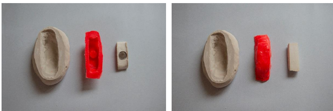
Ilustración 107 y 107.1. LAGUNA 1: Vista del contramolde, molde y pieza reproducida.
