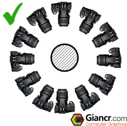
Ilustración 36. Situación de la cámara fotográfica alrededor del objeto que se desea registrar. (Fotografía extraída del enlace https://giancr.com/en/ )
