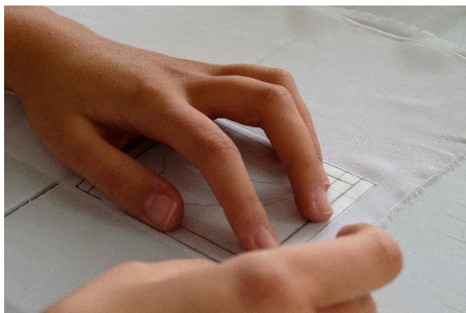
Ilustración 78. Transportando las dimensiones del patrón al tejido de seda.
