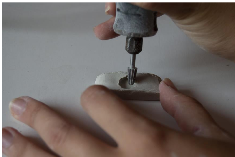
Ilustración 109. LAGUNA 1: Ajuste de las retenciones ubicadas en la concavidad destinada a albergar los imanes.
