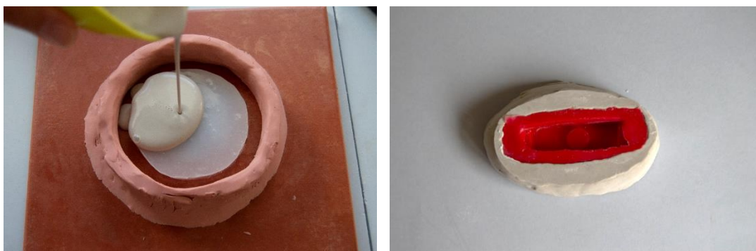
Ilustración 106. LAGUNA 3: Refuerzo de la silicona con un contramolde realizado en UltraCal 30. Ilustración 106.1. LAGUNA 1: Molde en silicona con su respectivo contramolde.
