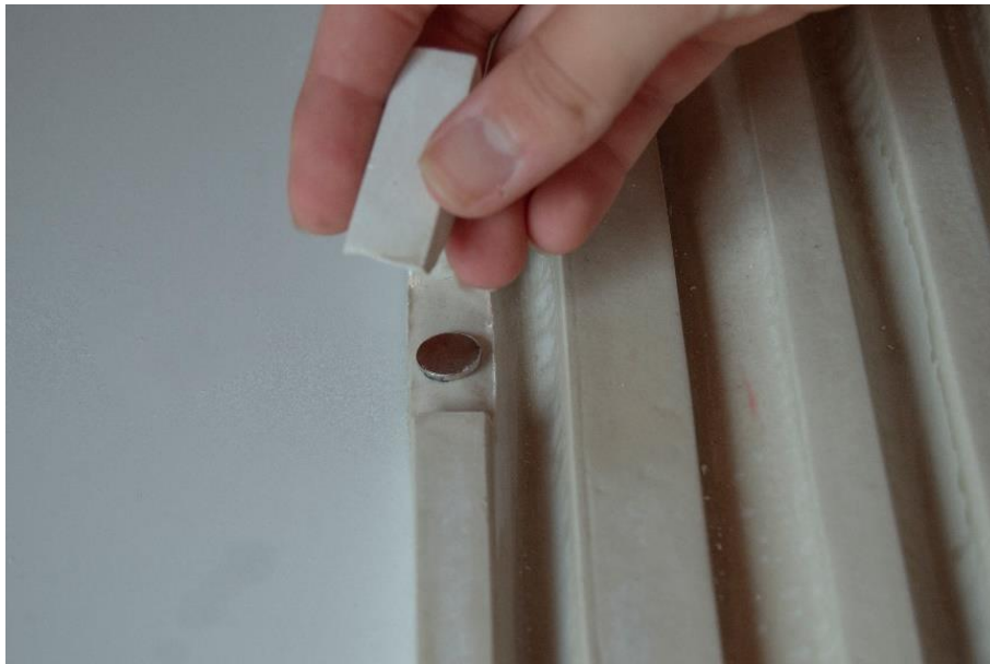
Ilustración 96. LAGUNA 1: Insertando el injerto magnético.
