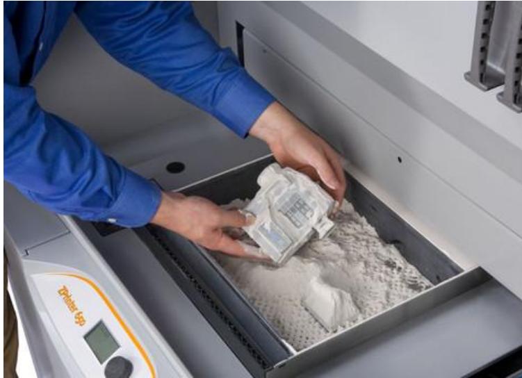
Ilustración 42. Impresora SLS en funcionamiento. (Fotografía extraída del enlace https://iutoms7001.wordpress.com/2016/10/30/tipos-de-impresoras-3d/ )
