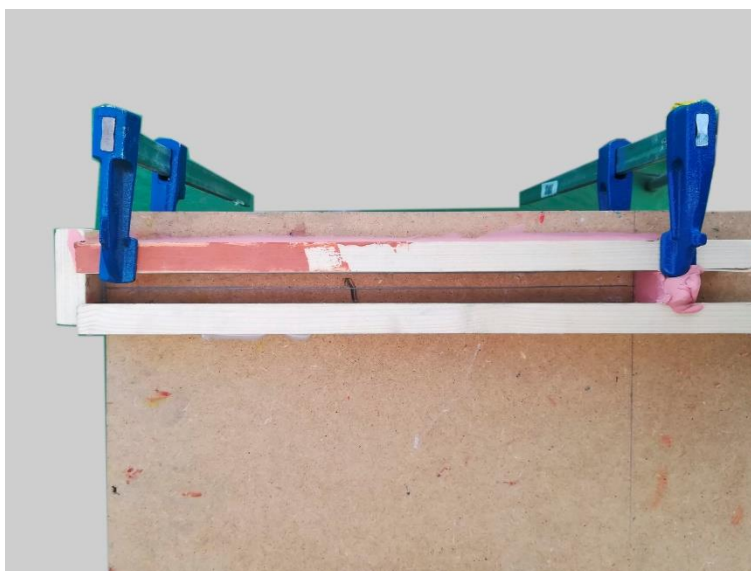
Ilustración 49. Encofrado realizado para obtener el lingote normal.
