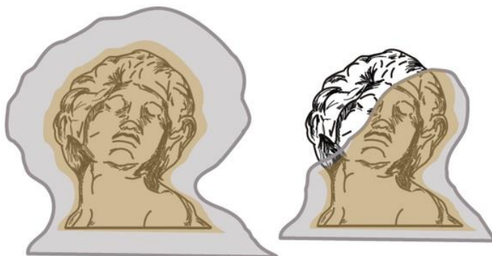
Ilustración 26. Representación de un molde perdido.
