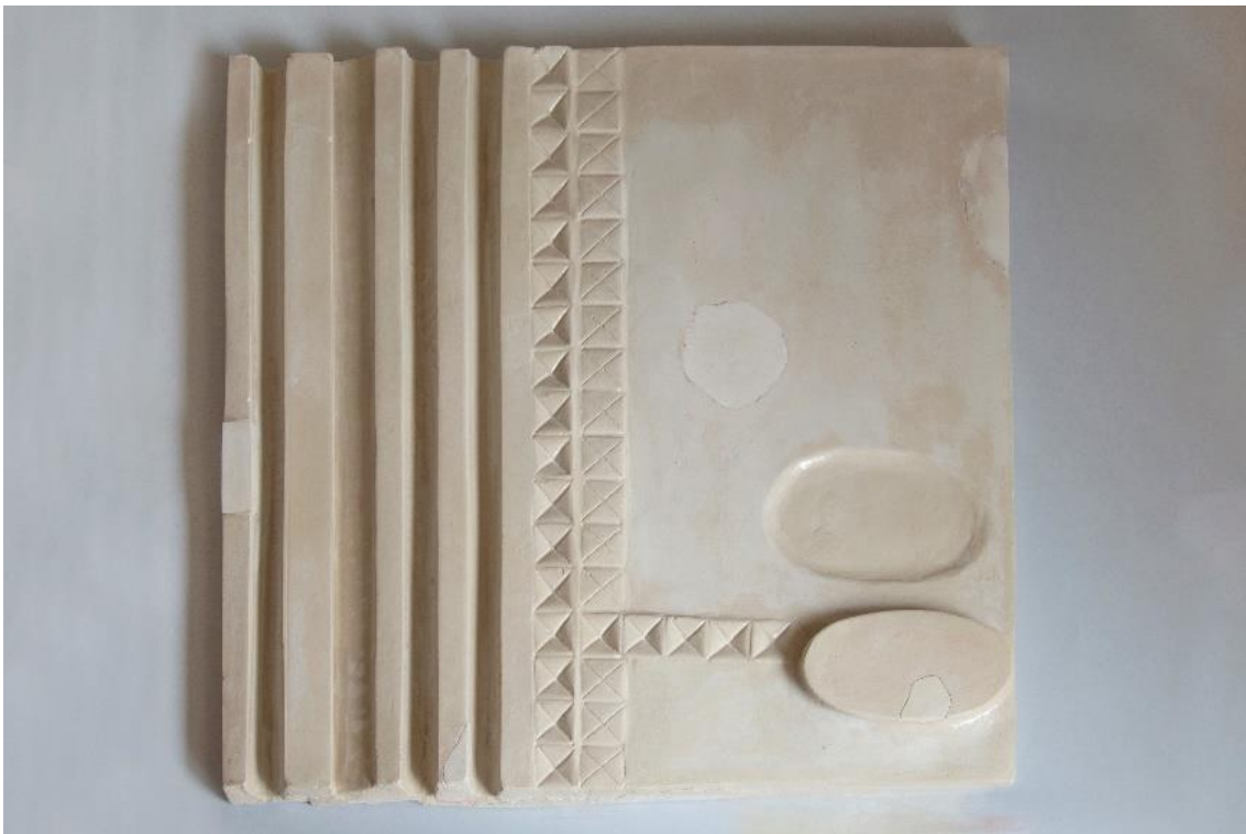
Ilustración 115. Supuesto escultórico con los cinco injertos. Reintegración magnética tridimensional.
