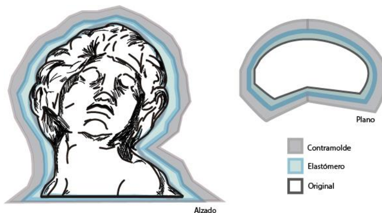
Ilustración 29. Esquema de un molde mixto.
