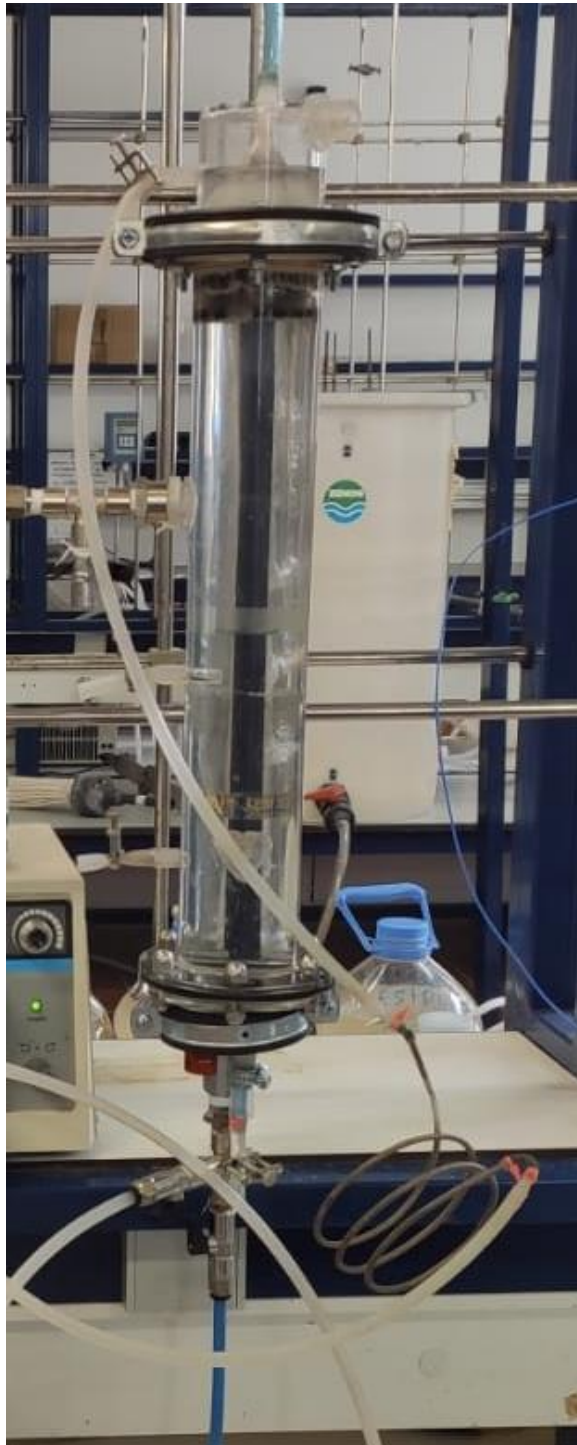
Ilustración 10. Reactor UASB empleado en la experimentación de laboratorio.
