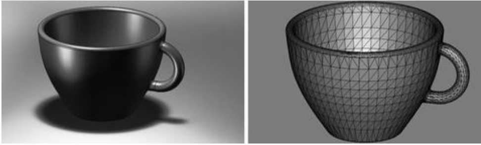
Fig. 4. Modelo CAD (izquierda) convertido a fichero STL (derecha) [5].
