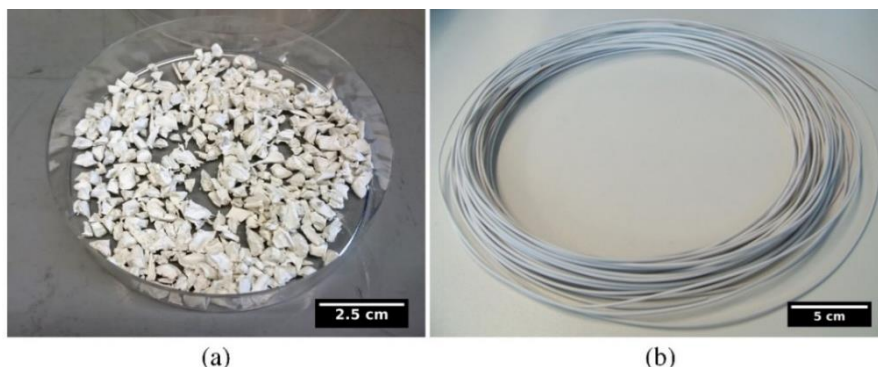
Fig. 43. (a) Mezcla de ABS y BT y (b) filamento de ABS-BT [143].
