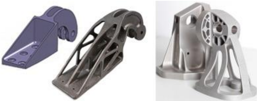
Fig. 51. Piezas antes y después de su optimización: pieza del Airbus A320 (izq.) y una pieza del Airbus A380 (dcha.) [149].
