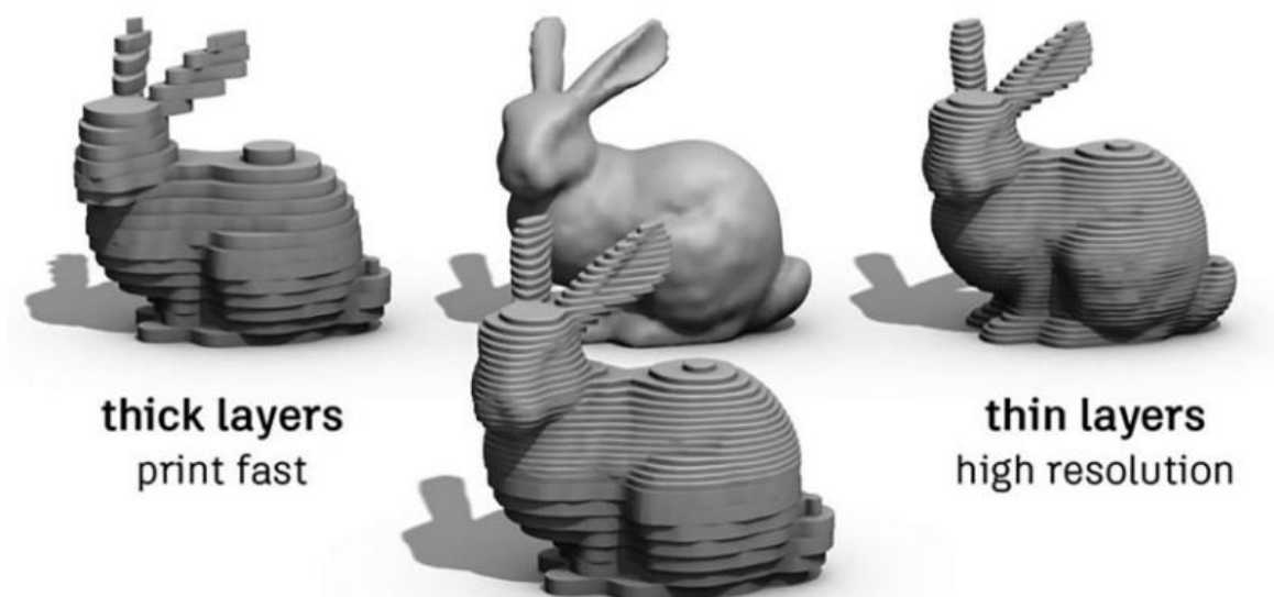
Fig. 5. Ejemplo de relación entre variables de impresión y la calidad del objeto [6].
