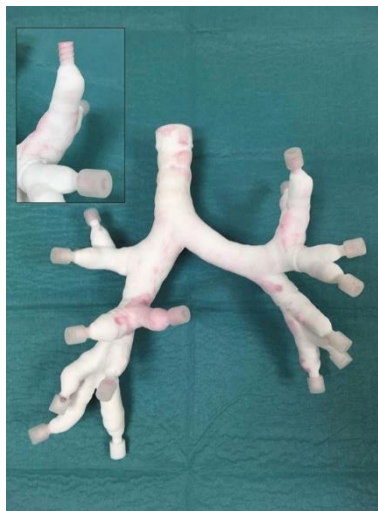
Fig. 46. Simulador para broncoscopia impreso mediante SLS con nailon [42].
