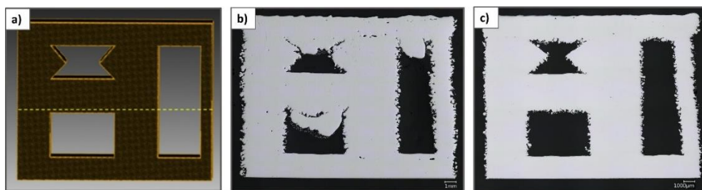
Fig. 25. Impresión de un archivo CAD (a) con parámetros de PBF (b) sin optimizar y (c) optimizados [92].
