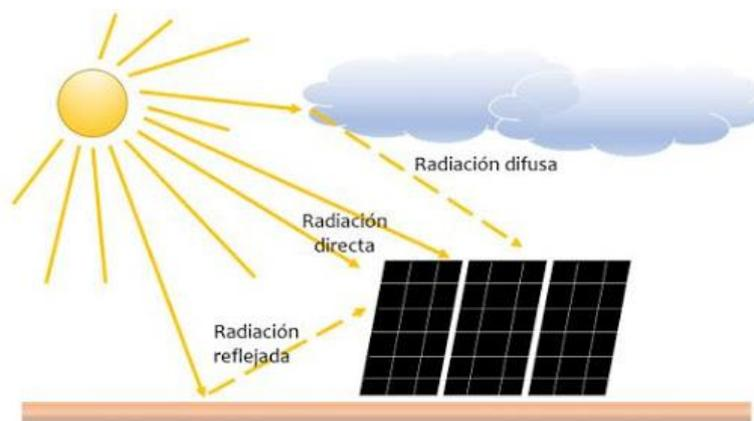
Ilustración 16 Componentes de la radiación solar [7]
