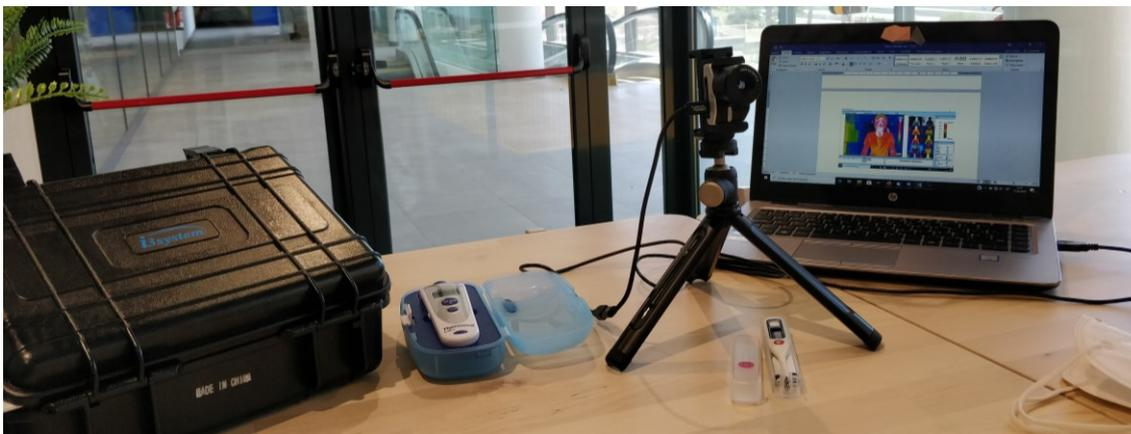
*Figura 26. Cámara infrarroja TE-V1, equipo de trabajo empleado (Fuente propia).*
