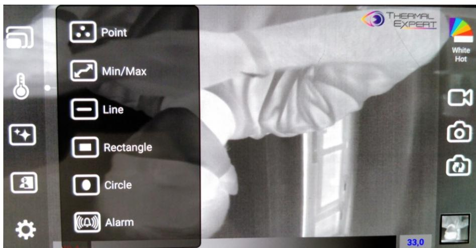
Figura 17. Cámara infrarroja TE-V1, formas de medir temperatura (Fuente propia).
