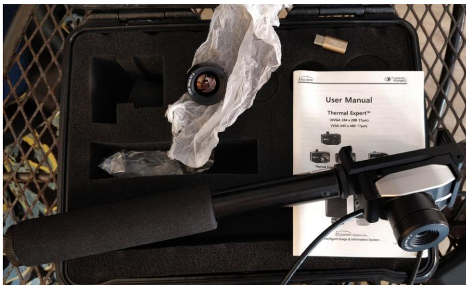
*Figura 14. Caja de componentes de la cámara termográfica TE-V1 (Fuente propia).*
