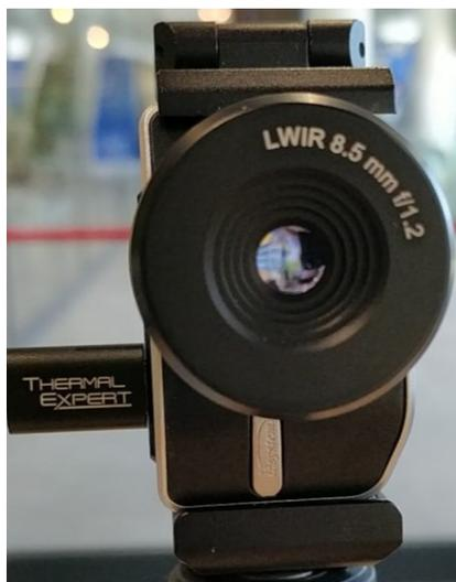
*Figura 15. Cámara infrarroja TE-V1 con lente de 8,5 mm y distancia focal de 1/1.2 (Fuente propia).*
