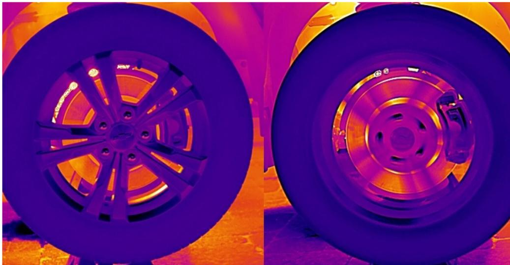
Figura 7. Imágenes térmicas del movimiento en alta velocidad un neumático (Izq.) tomada por una cámara refrigerada y la capturada por una cámara no refrigerada (Der.) [24].
