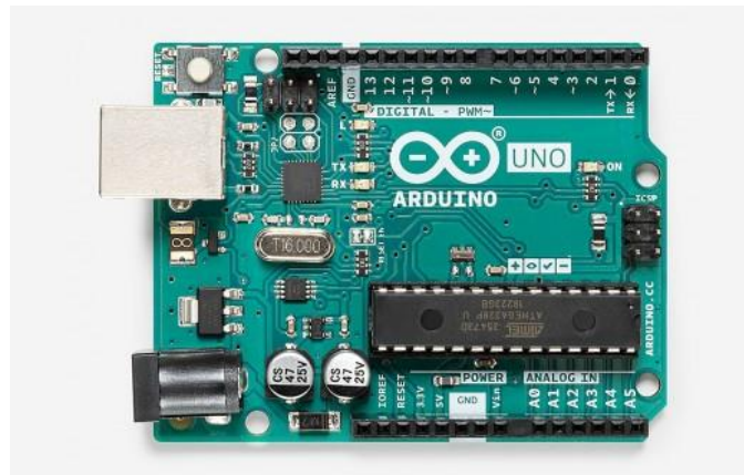
Figura 28: Placa Arduino UNO para la gestión de los sensores [14]
