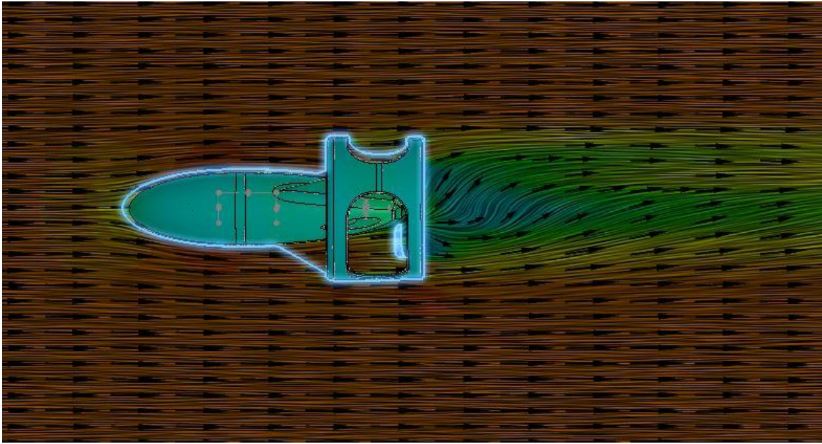
Figura 27: Resultado de simulación aerodinámica del conjunto ensamblado
