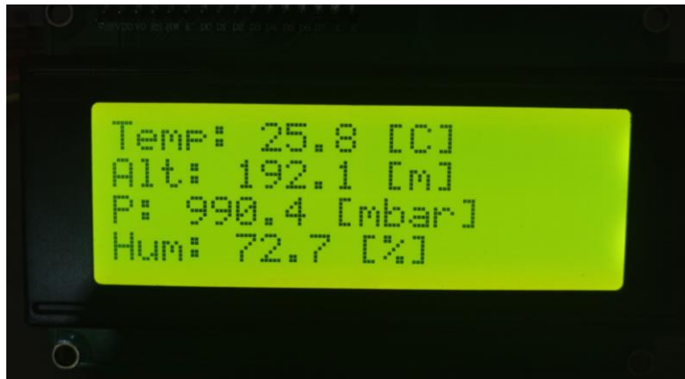
Figura 47: Pantalla LCD 20x4 con las lecturas de los sensores distribuidas
