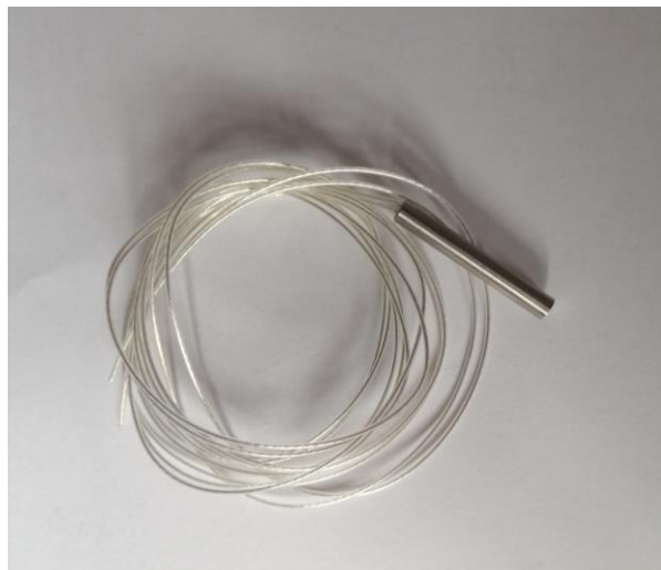
Figura 32: Sensor RTD PT100 cedido por el Departamento de Ingeniería Industrial de la ULL
