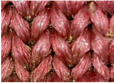
Figura 7.69. Microscopía taleguilla. Depósito de partículas en el tejido.
