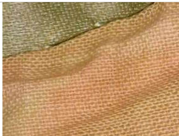
Figura 0.34. . Detalle de cosido de dos tejidos de forro y sangrado de tinte.
