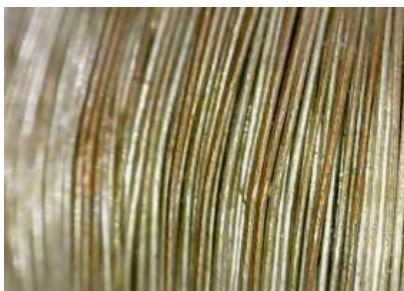
Figura 7.41. Microscopía chaquetilla. Pérdida de tonalidad plateada en la borla de un alamar.
