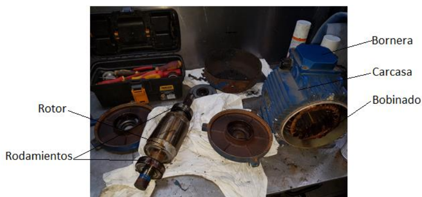
Figura 21. Motor eléctrico. Fuente propia.
