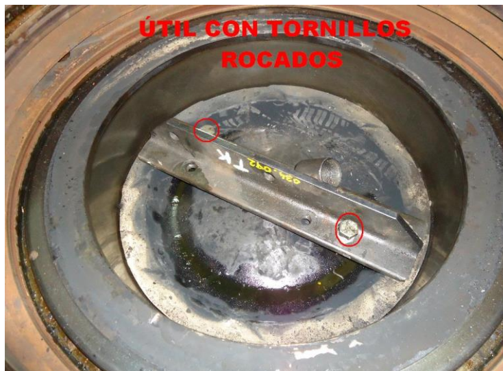
Ilustración 47. Útil de extracción de la cabeza del pistón
