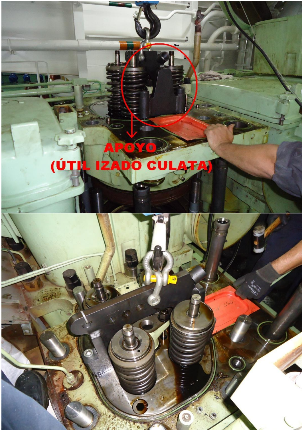
Ilustración 42. Izado de culata
