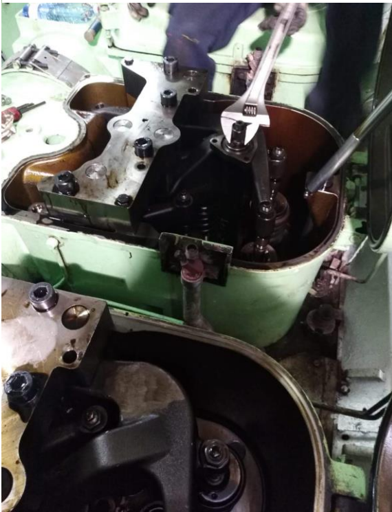
Ilustración 92. Extracción del inyector
