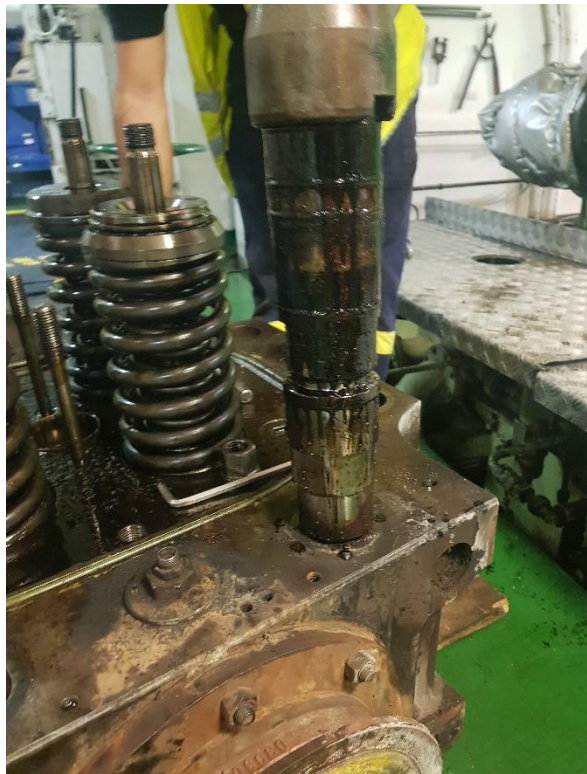
Ilustración 90. Inyector fuera de su alojamiento.
