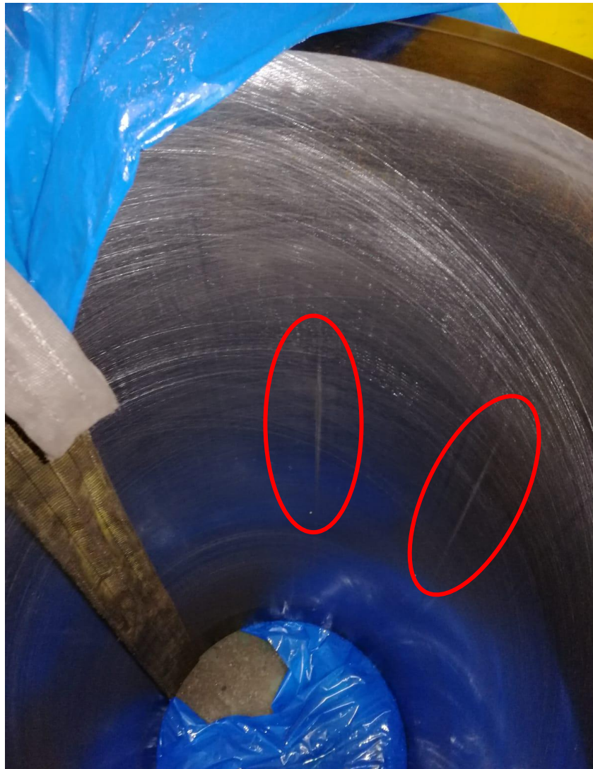
Ilustración 30. Camisa Fisurada de uno de los cilindros
