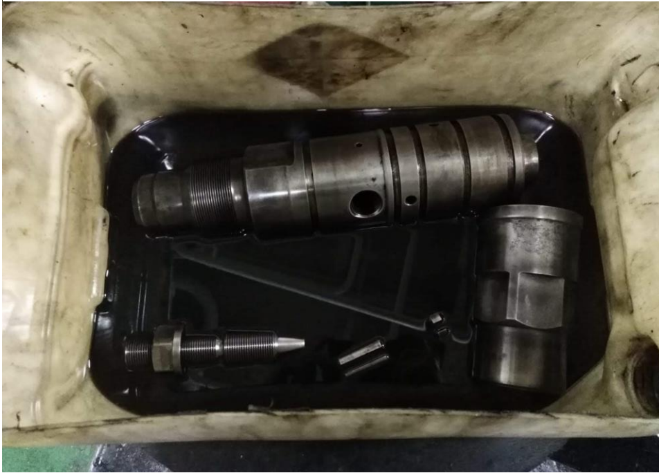
Ilustración 93. Inyector en química de limpieza
