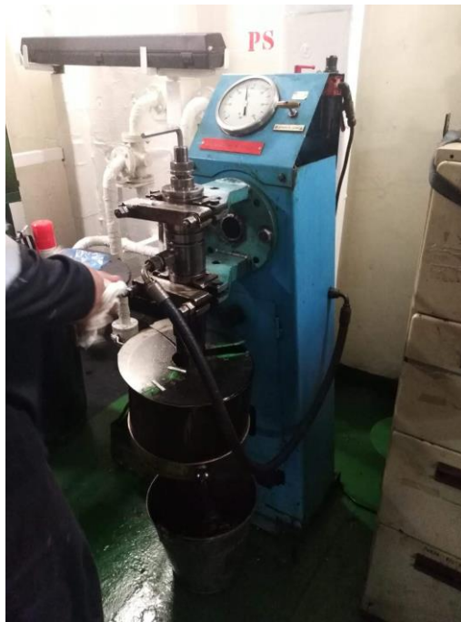
Ilustración 83. Tarado del inyector
