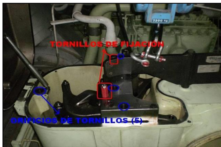
Ilustración 35. Desmontaje del culatín
