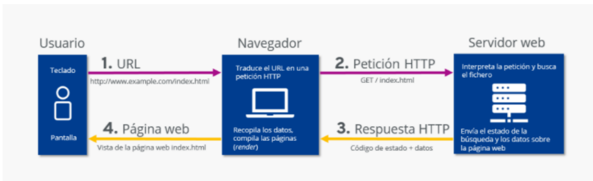
Figura 4: Esquema de comunicación HTTP.
