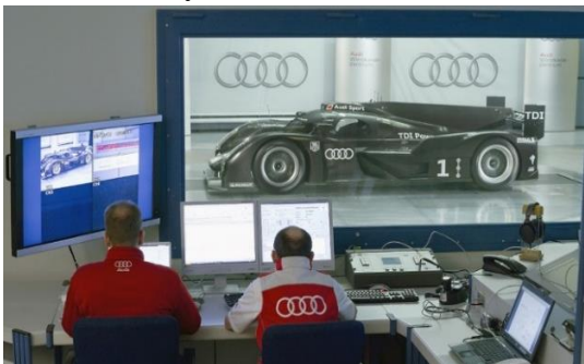
Ilustración 17. Ingenieros Aerodinámicos de Audi testeando el Audi R18 TDI en un túnel de viento. Fuente: motorsport.com
