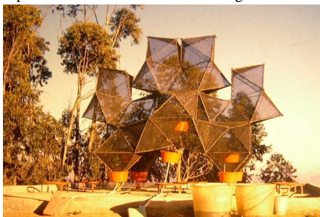
Ilustración 34. Captador tipo macrodiamante. Fuente: docplayer.es
