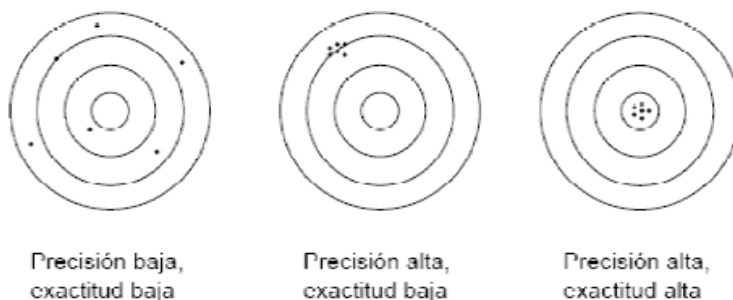
Ilustración 58. Diferencia entre precisión y exactitud. Fuente propia.
