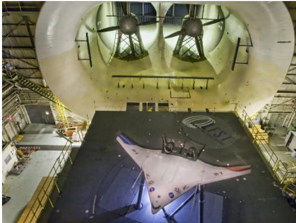
Ilustración 19. La aeronave Boeing X-48C en el túnel de viento de la NASA, Langley Research Center (Hampton, Virginia, EEUU). Fuente: nasa.gov
