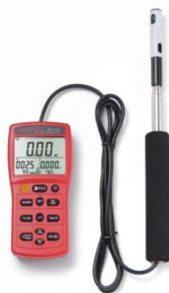
Ilustración 63. Anemómetro de hilo caliente Beha Amprobe TMA - 21HW. Fuente: rs-online.com
