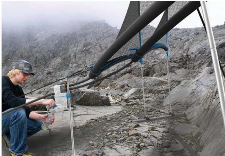
Ilustración 42. Demostración de recogida de agua desde el depósito de almacenamiento de Dropnet. Fuente: inhabitat.com
