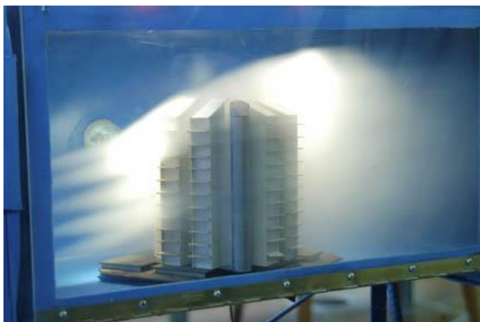
Ilustración 22. Maqueta azotada por una corriente de aire, en un túnel de viento de ingeniería civil, destinado a tests para medir la resistencia climática de puentes y edificios. Fuente: Universidad de Costa Rica.
