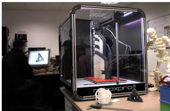
Ilustración 67. Impresora RoboxPRO en funcionamiento. Fuente: all3dp.com
