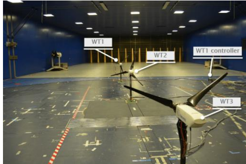
Ilustración 23. Ensayo en túnel de viento para determinar la disposición óptima de los aerogeneradores en una granja eólica. Fuente: Draper, Martín & Guggeri, Andres & López, Bruno & Díaz, A & Campagnolo, Filippo & Usera, Gabriel. (2018). A Large Eddy Simulation framework to assess wind farm power maximization strategies: Validation of maximization by yawning.
