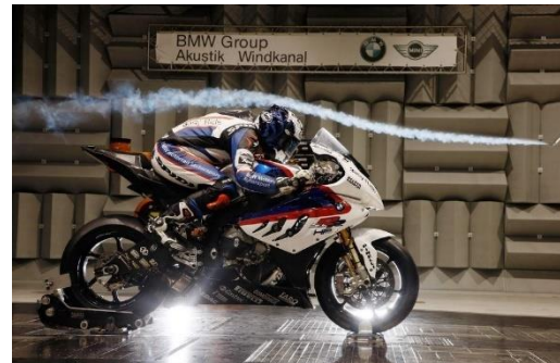
Ilustración 18. Pruebas aerodinámicas previas al campeonato internacional de Superbikes del modelo BMW S1000RR WSBK (Temporada 2011). Fuente: asphaltandrubber.com
