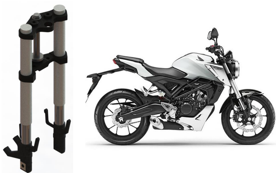
Ilustración 48. Renderizado de la horquilla telescópica invertida adquirida y Motocicleta Honda CB125R 2018. Fuente: honda.com.
