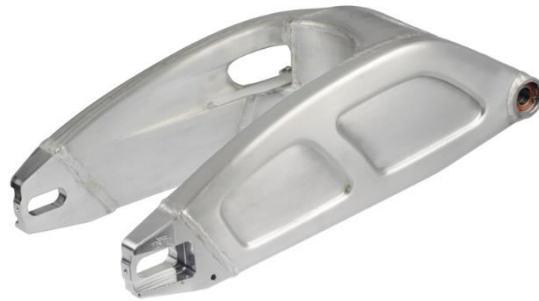
Ilustración 19. Basculante de doble brazo triangulado de motocicleta Honda NSF250R. Fuente:ordremedecins.mc
