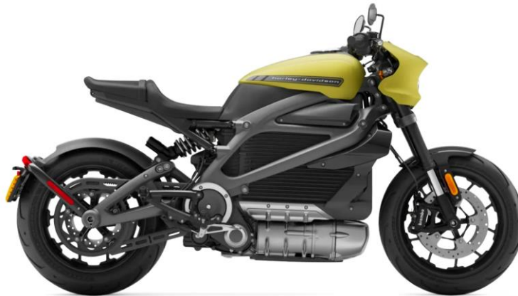
Ilustración 24. Motocicleta eléctrica Harley Davidson Livewire del año 2020 con sistema de amortiguación cantiléver. Fuente: harley-davidson.com
