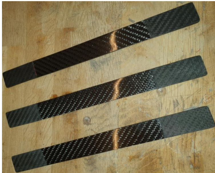
Ilustración 38. Probetas tipo A para fabricadas para el ensayo de tracción.
