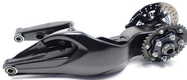
Ilustración 20. Basculante monobrazo de la motocicleta KTM 1290 Super Duke R. Fuente: rubbersideup.com
