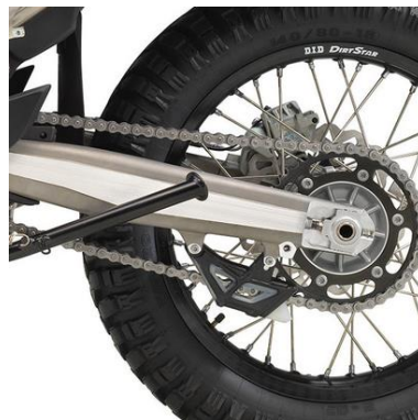
Ilustración 18. Basculante de doble brazo simple de motocicleta KTM 690 enduro R. Fuente: ktm.com
