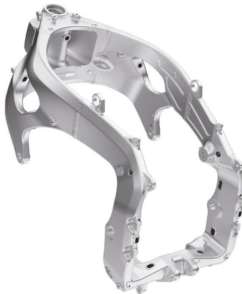
Ilustración 14. Chasis de aluminio de Honda CBR1000RR-R Fireblade del año 2020. Fuente: Motociclismo.com
