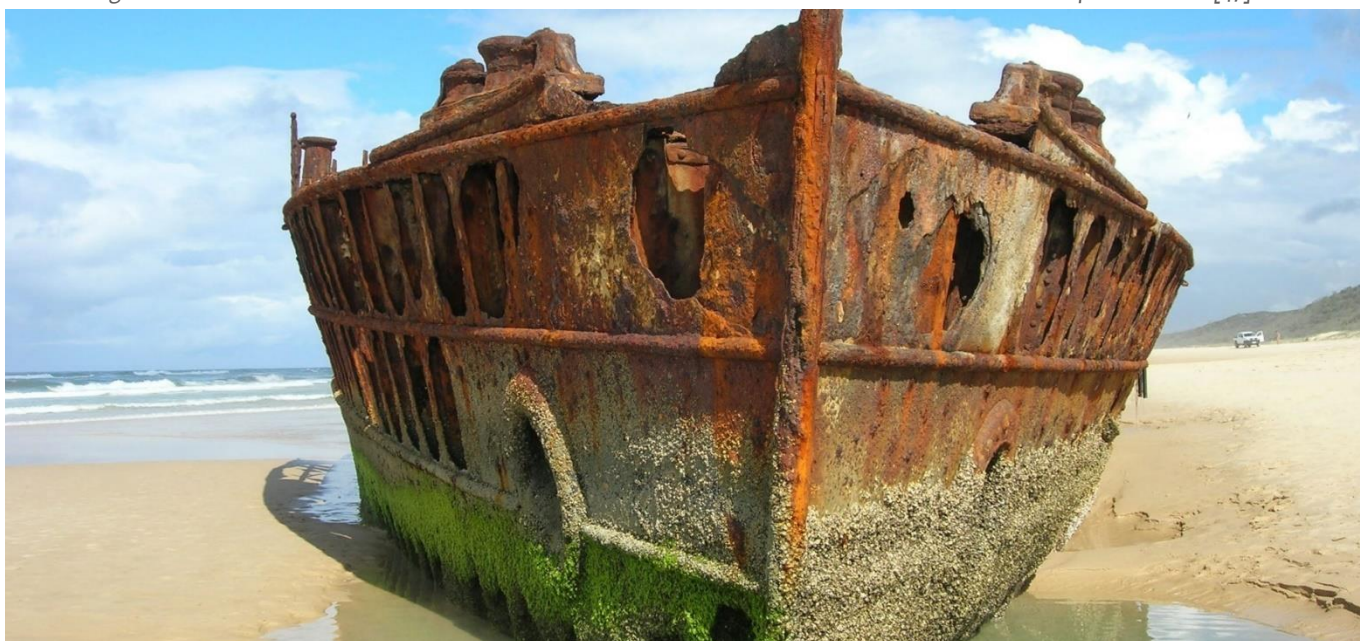
Figura 22. Estructura metálica de una embarcación sometida a la inevitable acción de la corrosión. Reproducido de [47].
