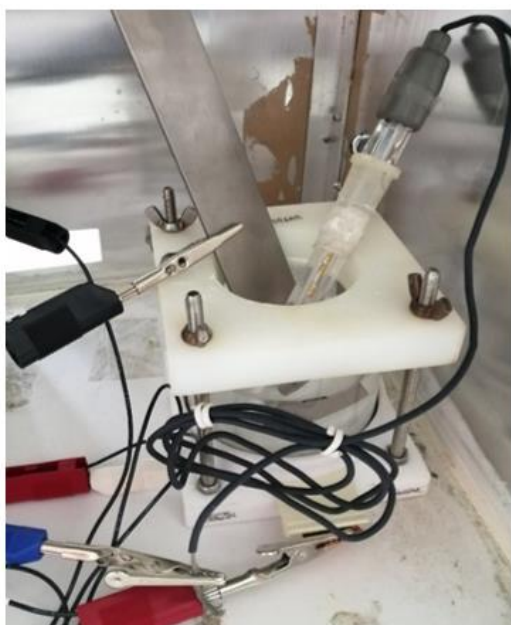
Figura 23. Fotografía a la izquierda de la celda electroquímica de tres electrodos empleada para los ensayos realizados en este TFM. Dibujo a la derecha de una celda electroquímica “tipo” de las mismas características donde se pone de manifiesto la situación de cada electrodo con mayor claridad (reproducida de [40]).
