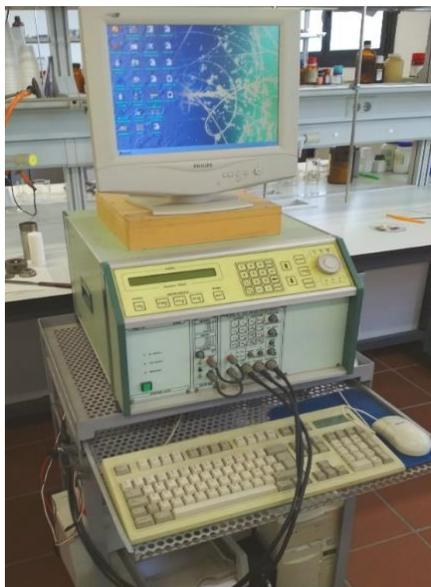
**Figura 8.** Potenciostato usado para las electrodeposiciones.
