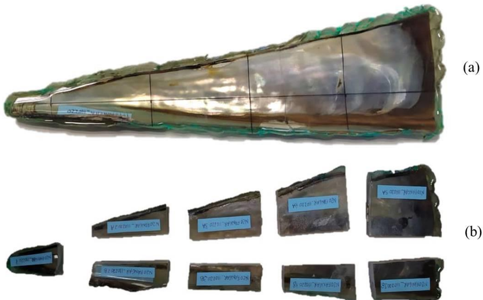
Figura 8. Lóbulo dorsal del nácar (LDN) embebido en resina epoxi (a) y cortado transversal y longitudinalmente (b).
