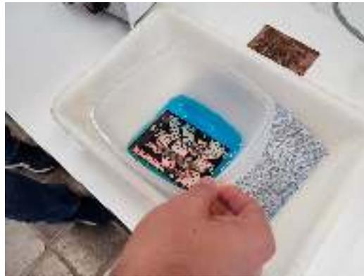
Figura 5.5: Ataque químico a la placa de cobre
