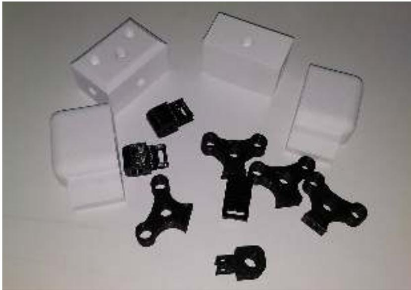
Figura 6.6: Piezas de estructura de soporte impresas
