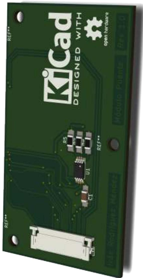
Figura H.3: Visualización 3D del módulo puente para el sensor OV5680
