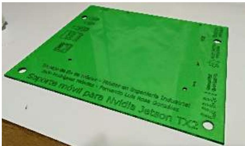
Figura 6.8: Mesa de soporte de NJTX2 fabricada
