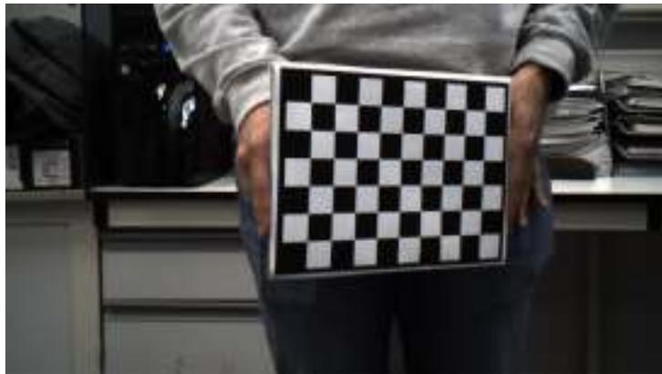
Figura 8.6: Patrón para el cálculo de parámetros de cámaras
