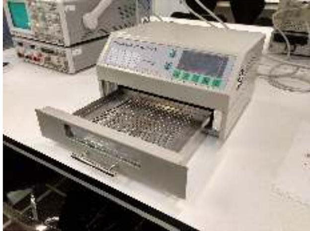
Figura 2.3: Horno de soldadura T962
