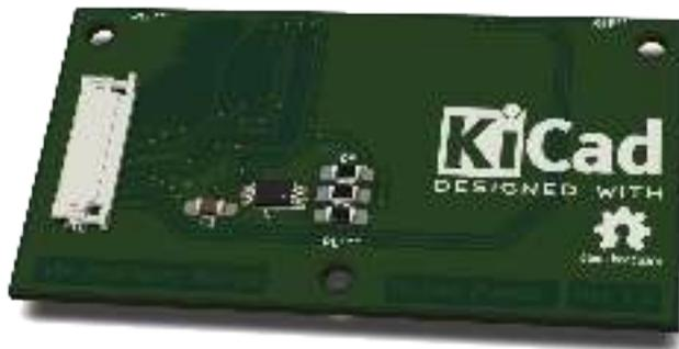
Figura 4.14: Visualización 3D del módulo puente para el sensor OV5680
