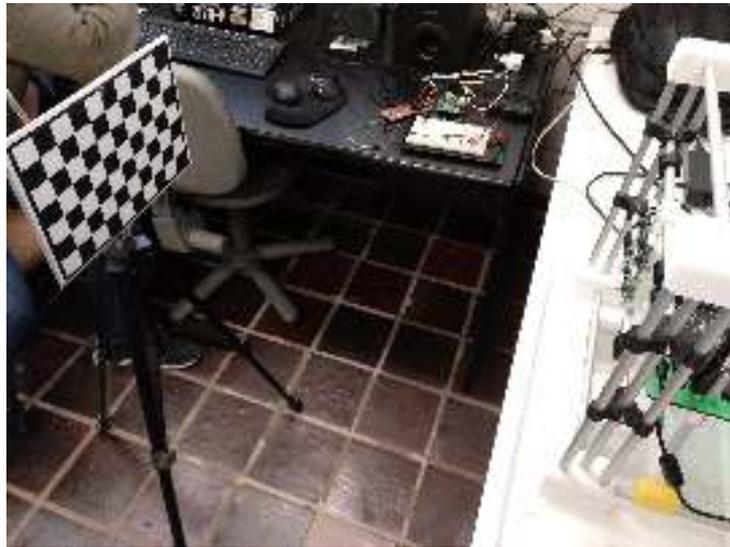
Figura 8.4: Montaje para ajustar el ángulo de apuntado de las cámaras
