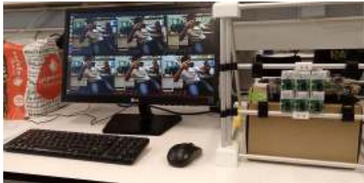
Figura 8.1: Streaming de vídeo en tiempo real de 6 cámaras con *Gstreamer-1.0*
