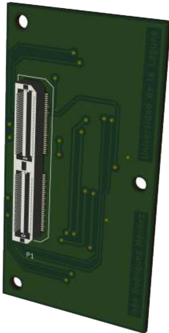
Figura H.6: Visualización 3D del módulo puente para el sensor IMX219/OV5647
