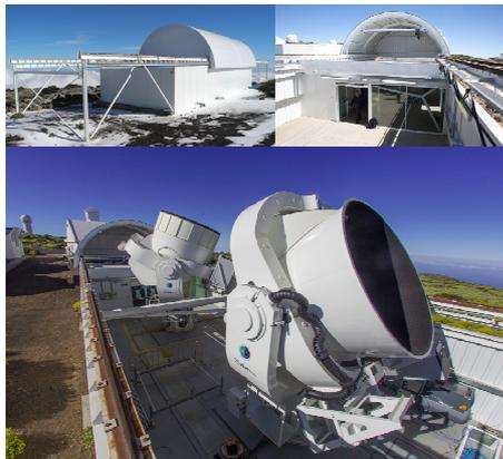
Figura 2.1: Imágenes del experimento QUIJOTE en el Observatorio del Teide. Arriba: vistas de la cúpula desde el exterior e interior. La cúpula está orientada en la dirección Norte-Sur. Abajo: disposición final de los dos telescopios, QT1 (al fondo) y QT2.
