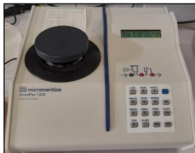
Figura 5. Picnómetro de Helio, Accupyc 1330 ( Micromeritics ). Laboratorio de Caracterización de Partículas y Microsuperficies, SEGAI-ULL.
