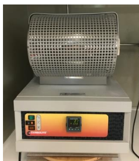
Fig.4. Horno empleado para el tratamiento térmico.
