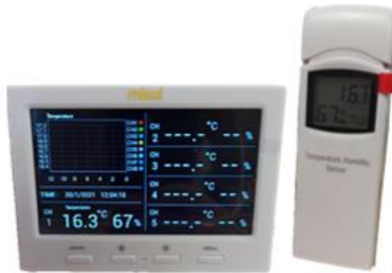
Imagen 4. Estación meteorológica y sensor de temperatura y humedad.
