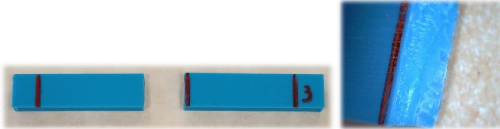
Figura 81. a) Imagen después del ensayo de flexión de una probeta impresa a 260 °C y b) fotografía realizada tras el ensayo de flexión, con un microscopio digital, a una muestra impresa a 260 °C.
