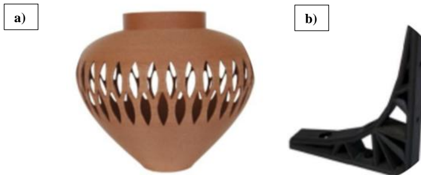
Figura 21. Piezas realizadas mediante un filamento base con la adición de una fibra para mejorar sus propiedades. a) PLA junto con fibra de madera y b) PET junto con fibra de carbono [27].
