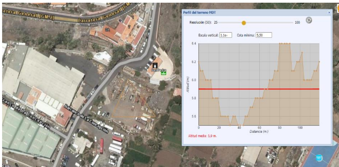
Figura 7.7: Cota del terreno seleccionado con respecto el nivel del mar. Fuente: grafcan.es
