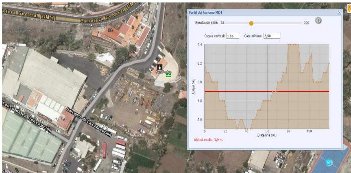
Figura 1.3: Cota del terreno seleccionado con respecto al nivel del mar. Fuente: grafcan.es
