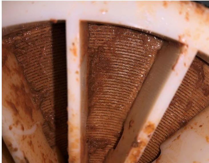
Figura 1.7: Ensuciamiento de una membrana en espiral. Fuente: kleinscale.com
