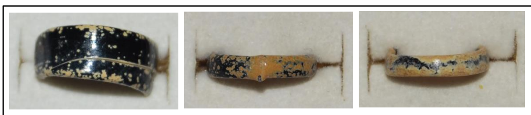
Lámina 5.21.- Progresión de la desvitrificación en forma de puntos amarillos (de izquierda a derecha: C93-0907, C93-0903 y C95-0924) (fotografía ARPA)
