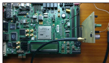
(b) DAC insertado en la Virtex-5
