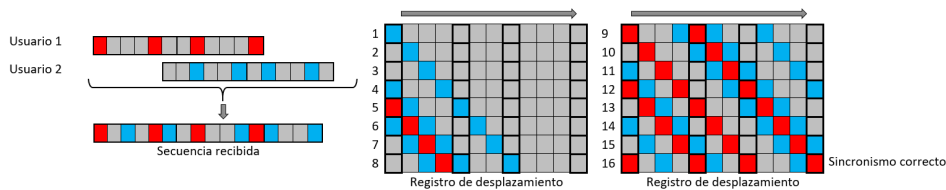
Figura 4.5: Ejemplo de sincronización para dos usuarios usando m = 2 bits de sincronización.
