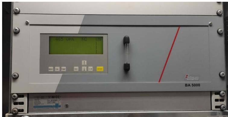
*Ilustración 38: Analizador de NO<sub>x</sub> modelo BA 5000 de Bühler Technologies*
