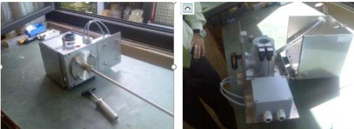
*Ilustración 37: Sonda de muestra de los gases de escape*
