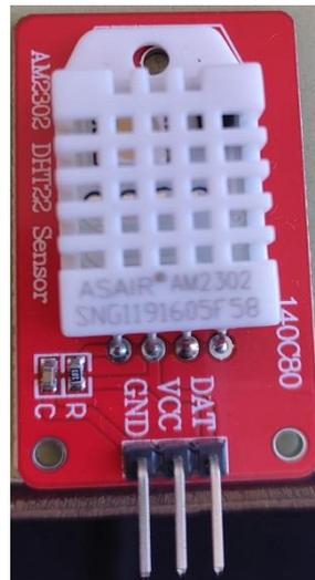
*Figura II.13 Sensor de temperatura y humedad DHT22*
