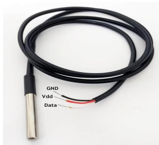
*Figura II.15 Sensor encapsulado DS18b20*
