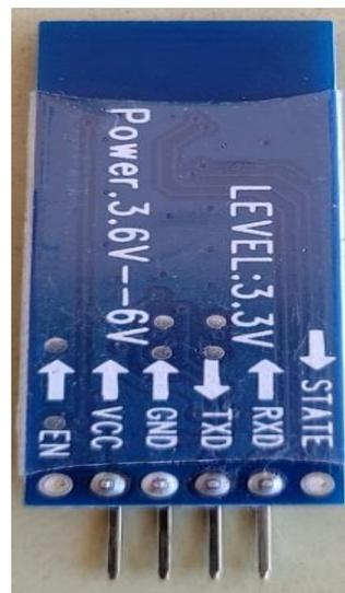
Figura II.31 Parte anterior del HC-06      Figura II.32 Parte posterior del HC-06
