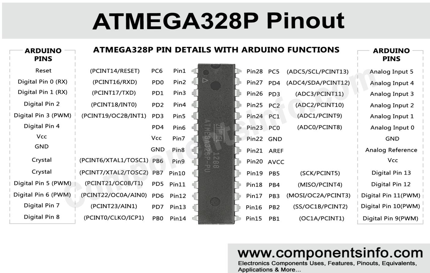
Figura II.1. Definición de pines ATmega328P-Pu
