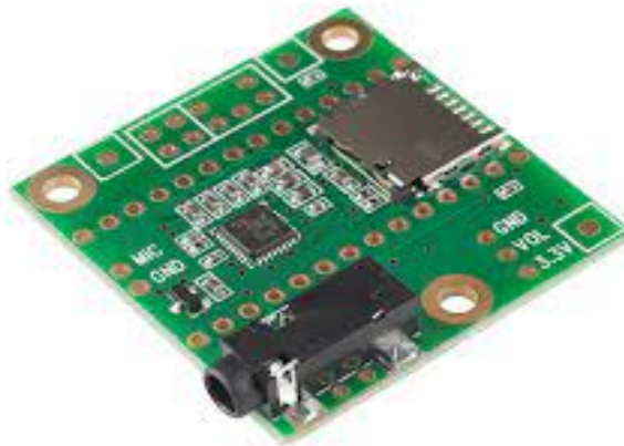
Figura 7.2.1e. Adaptador de Audio para Teensy 3.6
