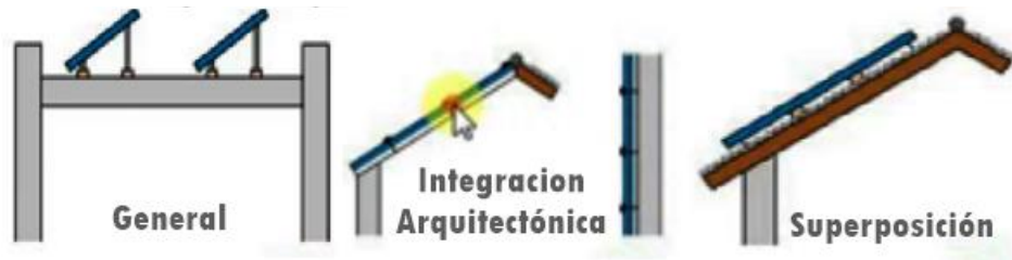
Ilustración 14: tipos de colocación de paneles
