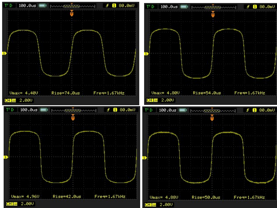
Figura 32. Respuesta en el circuito real a medida que desplazamos el potenciómetro
