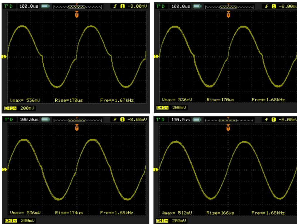
Figura 21. Corrección de la distorsión de cruce para varios valores del potenciómetro
