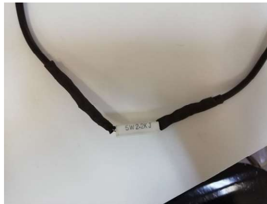
Figura 101. Resistencia descargadora de los condensadores.
