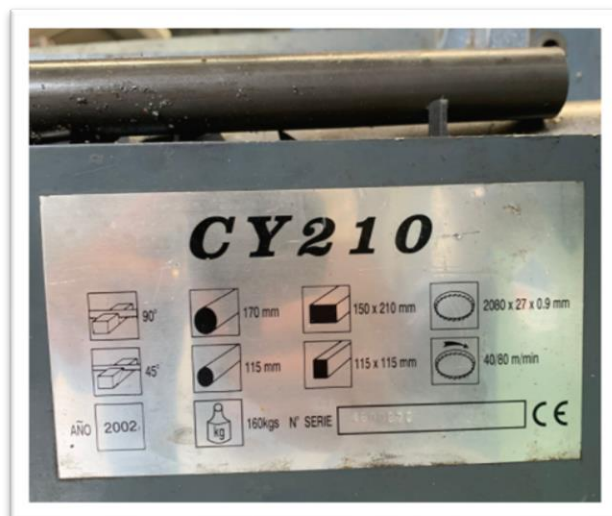
Figuras 1 y 2: sierra de cinta empleada junto con su marca y detalles técnicos.
