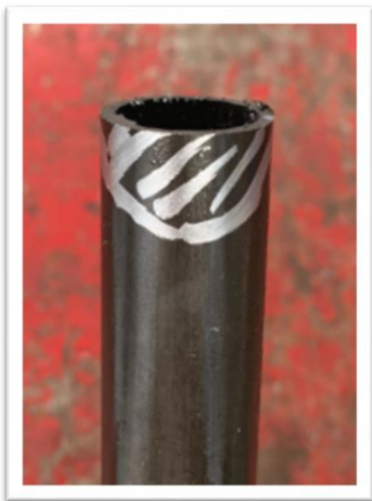
Figuras 6 y 7: preparación del extremo de la barra para realizar el corte en boca de pez.
